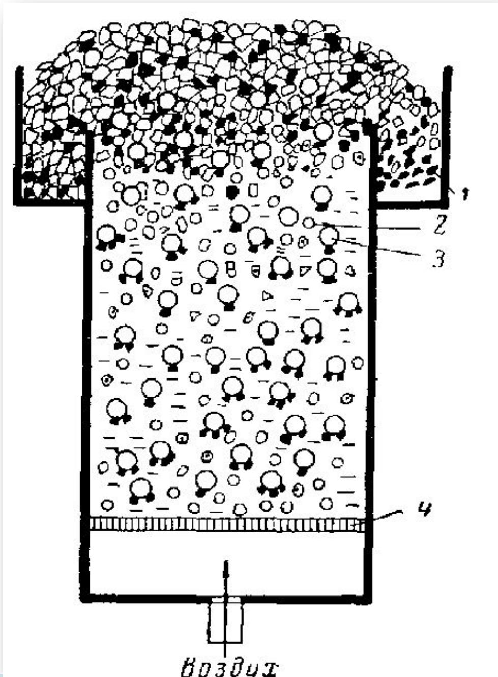
□ Пенная флотация — гораздо более производительный процесс, чем масляная и плёночная флотации. Этот метод применяется наиболее широко.
