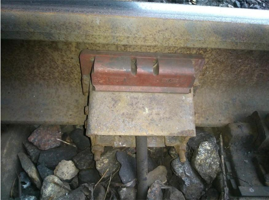
Датчик крепится к подошве рельса двумя крюками с гайками на 17
