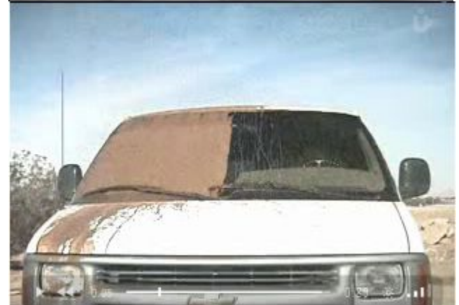
Нанопокрyтие для автомобильного стекла. На верхнем рисунке обработана левая половина лобового стекла, на нижнем – правая
