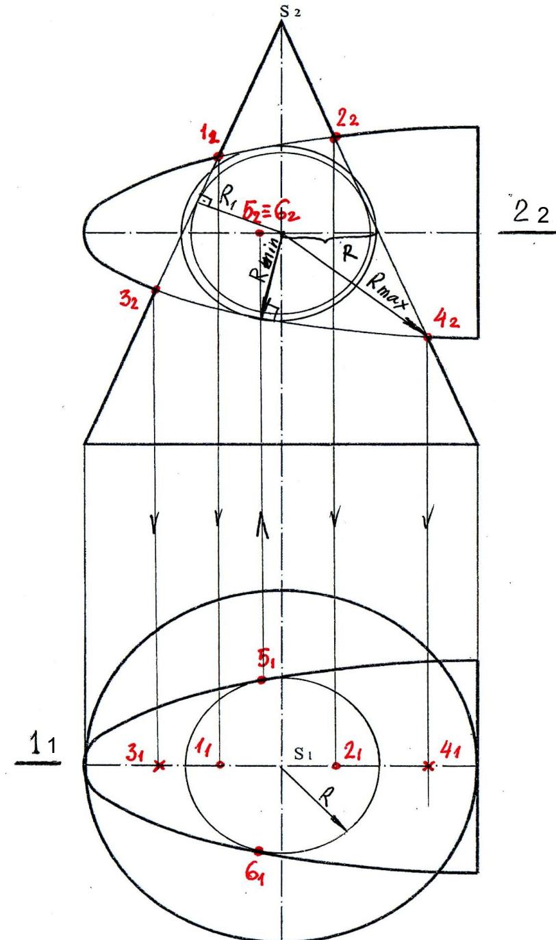
8. Т.к. минимальная сфера является соосной с искомыми поверхностями, определяем общие параллели сферы с конусом и параболоидом. На П2 они проецируются в прямые, перпендикулярные осям поверхностей, проведенные в точках пересечения очерков соответствующих поверхностей со сферой. Получили две параллели по конусу и одну- по параболоиду.
