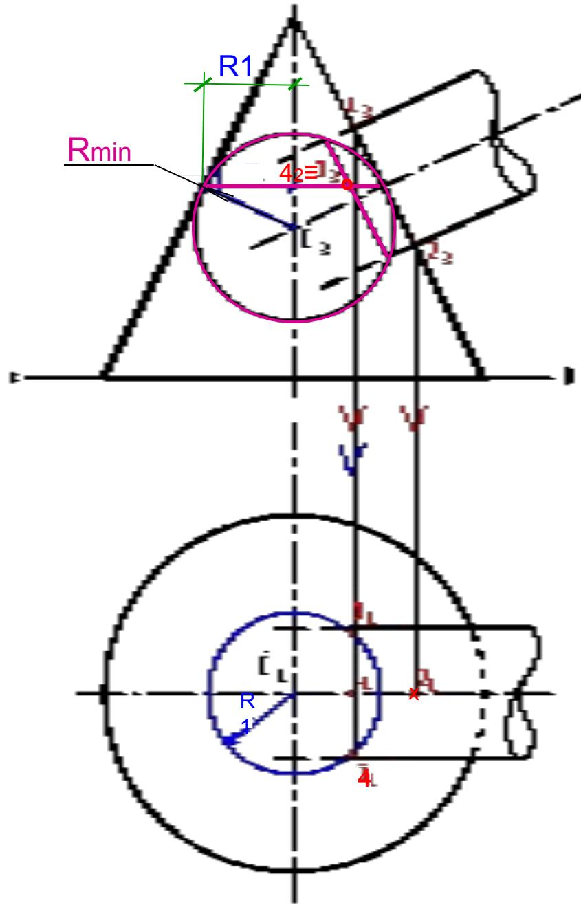
Задаем сферу произвольного радиуса, больше минимальной, но меньше максимальной. Она рассекает конус по двум окружностям радиусами  $R_2$  и  $R_3$ , и цилиндр по одной. Окружности, пересекаясь, дают (...) 5, 6, 7, 8 принадлежащие одновременно трем поверхностям: искомым и сфере-посреднику. На П1 строим горизонтальные проекции точек 51 - 81, как лежащие на поверхности конуса (т.е. на окружностях радиусами  $R_3$  и  $R_2$  соответственно) с учетом видимости поверхностей.
