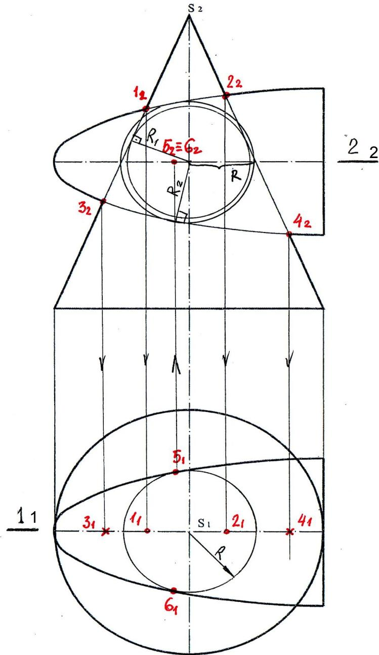
7. Определяем максимальный радиус сфер – посредников. Он равен наибольшему расстоянию от центра сферы до точек накладки главных меридианов.  $R_{\max}$  = расстоянию до точки **4<sub>2</sub>**
