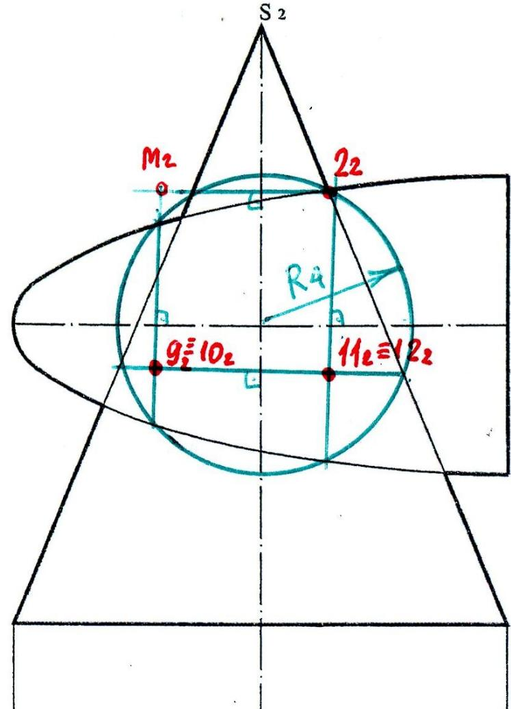
Для определения горизонтальных проекций найденных точек построим на П1 окружность радиусом  $R5$ , на которой лежат точки 9, 10, 11, 12.
