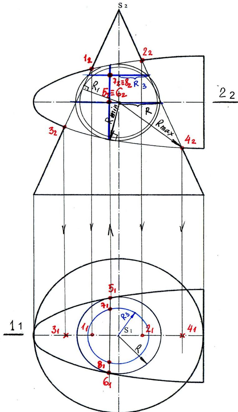
9. Сфера максимального радиуса пересекает параболоид по двум параллелям и конус по двум параллелям. В результате находим одну точку **4** (точку касания двух окружностей). Мы ранее нашли (.)**4** с помощью плоскости-посредника 1.
