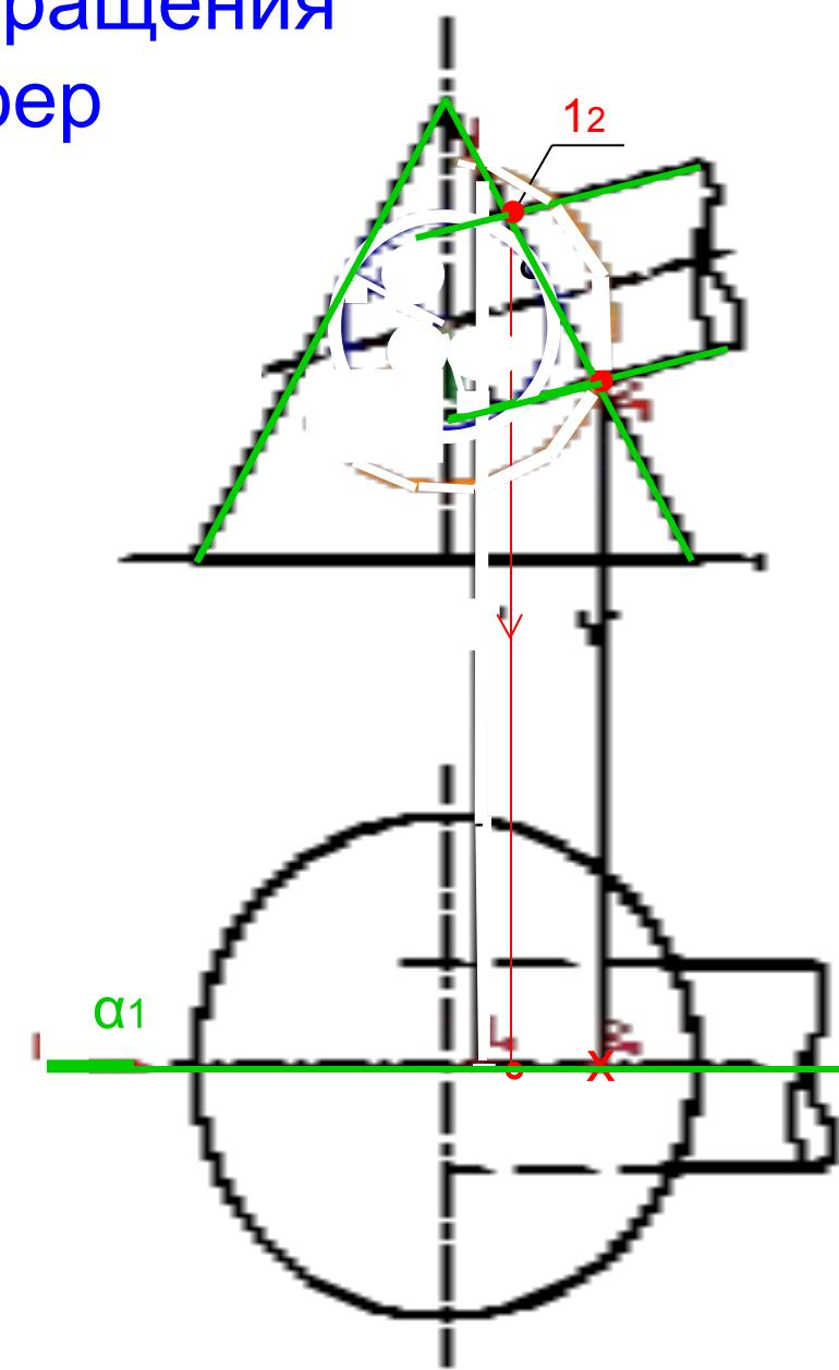
Определяем радиус минимальной сферы (должна коснуться обеих поверхностей или коснуться одной и пересечь другую). Сфера радиуса  $R_{Ц}$ , касательная к цилиндуру, не имеет общих параллелей с конусом.
