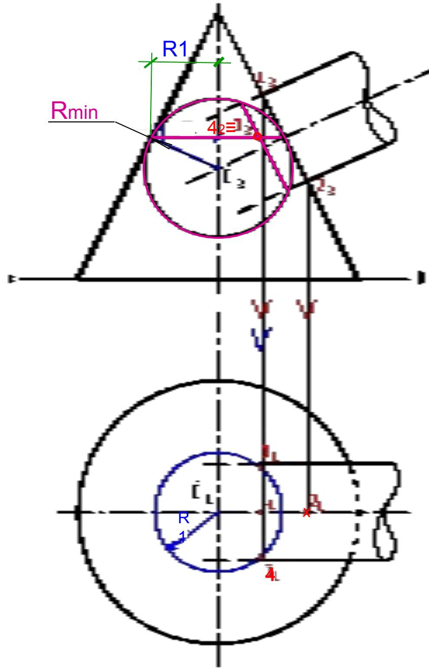
На плоскости  $\Pi_1$  находим горизонтальные проекции  $3_1$  и  $4_1$  по линии связи на окружности радиуса  $R_1$ , принадлежащей поверхности конуса. Данная окружность параллельна  $\Pi_1$  и проецируется без искажения. Определяем видимость горизонтальных проекций точек:  $3_1$  и  $4_1$  видимы, т.к. находятся в верхней части цилиндра (это видно на  $\Pi_2$ - выше оси цилиндра)
