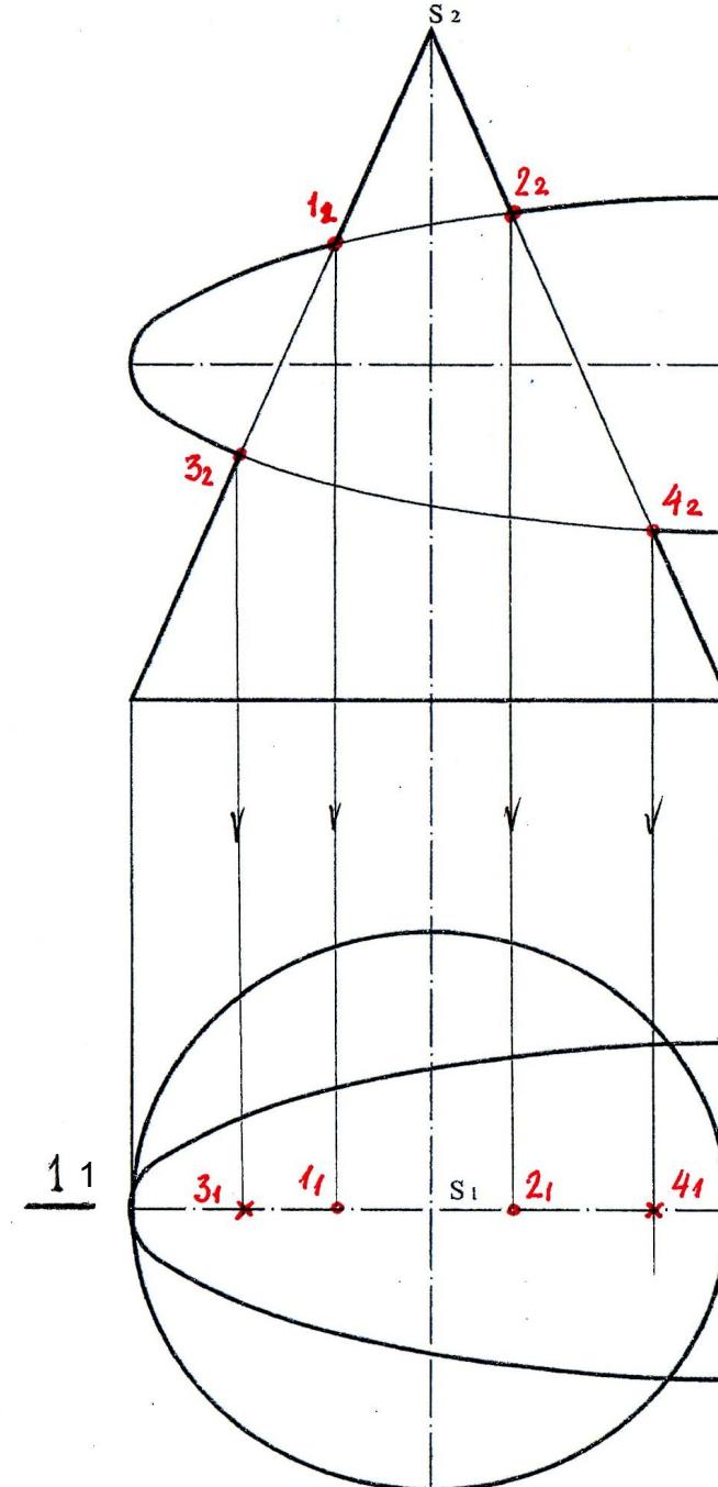
2. Проверяем, можно ли еще взять вертикальные плоскости-посредники, параллельные П2. В сечении по конусу получим гиперболу, по параболоиду вращения -параболу. Обе кривые требуют времени для построения. **Вывод: больше вертикальные плоскости использовать нельзя.**
