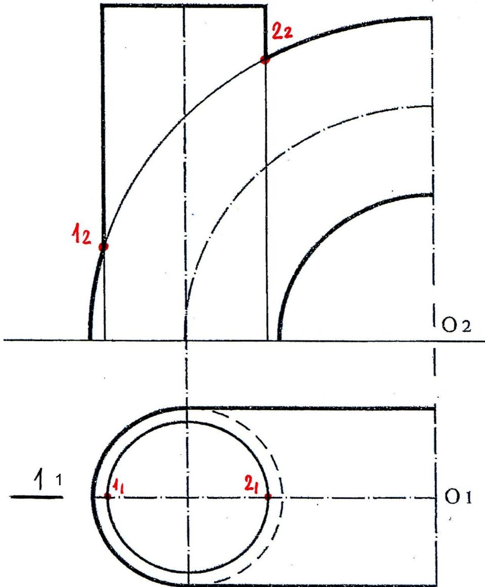
2. Далее применим метод эксцентрических сфер - посредников. Через ось тора (центр  $O_2$ ) проведем фронтально-проецирующую плоскость 2 (2<sub>2</sub>), которая разрежет тор по окружности с центром в точке N (N<sub>2</sub>) (на П2 окружность совпадает с проекцией плоскости 2<sub>2</sub>). Восстановим к плоскости окружности перпендикуляр в (.) N (N<sub>2</sub>) и найдем его пересечение с осью цилиндра -(.)K (K<sub>2</sub>) - это центр сферы-посредника
