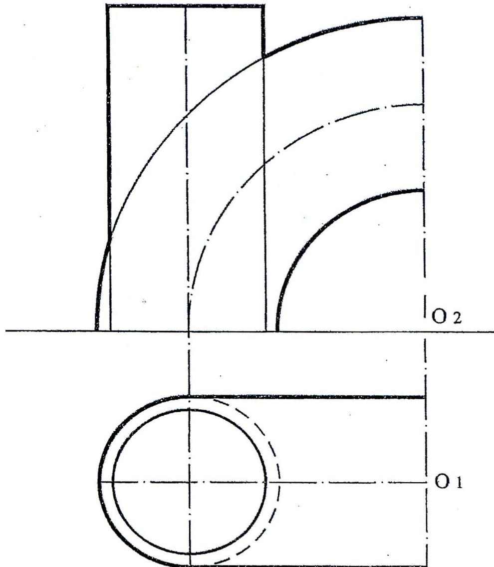
1. Проведем плоскость –посредник №1 по плоскости симметрии двух поверхностей. В сечении по цилинду получим прямоугольник (очерк цилиндра на П2), по тору – сектор между двумя очерковыми окружностями. Накладка двух сечений позволяет определить общие точки 1 и 2
