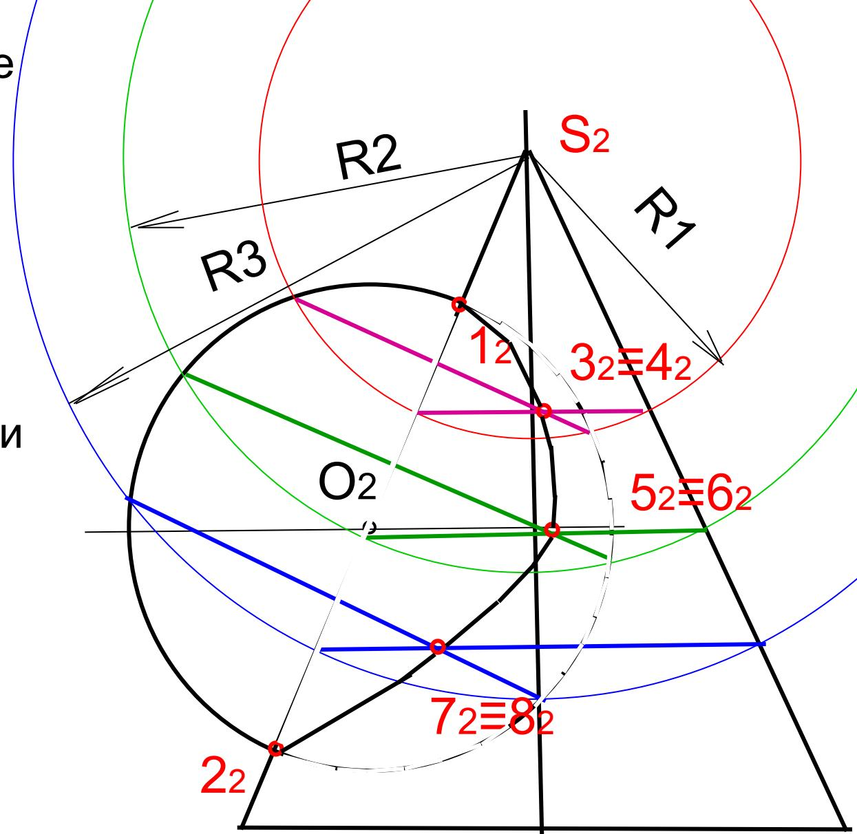
Поверхности конуса и цилиндра с общей фронтальной плоскостью симметрии касаются сферы по **линиям 1-2 и 3-4**. Линии пересечения поверхностей представляют собой эллипсы, плоскости которых перпендикулярны П2.
