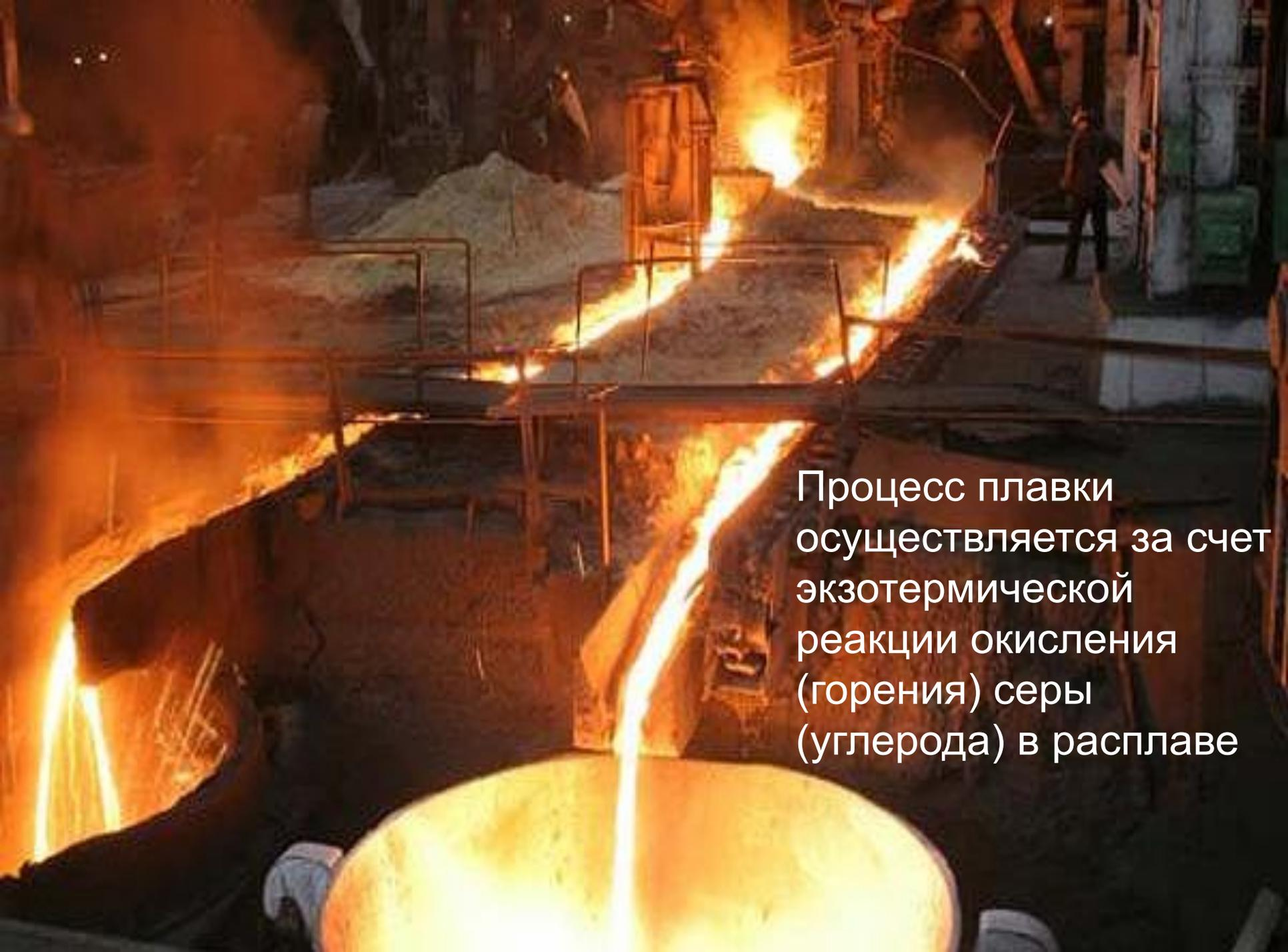
Процесс плавки осуществляется за счет экзотермической реакции окисления (горения) серы (углерода) в расплаве
