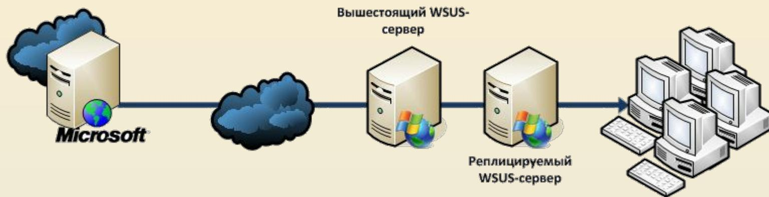
Рисунок 3- Структура иерархического развертывания
