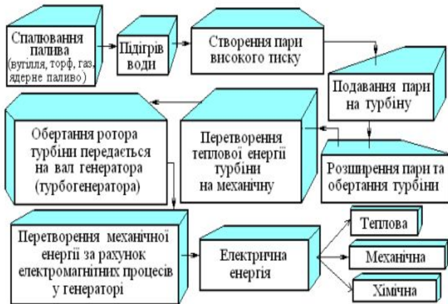
Рисунок 1.5 – Схема надходження та розподілу електричної енергії на теплових і атомних електростанціях
