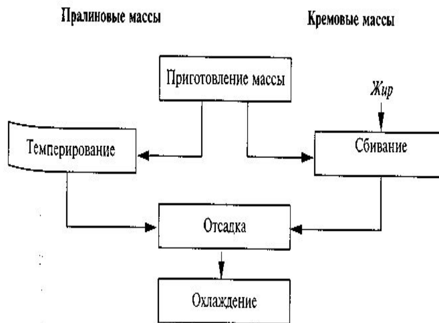
Рис. 28. Технологическая схема производства конфет из масс пралине
