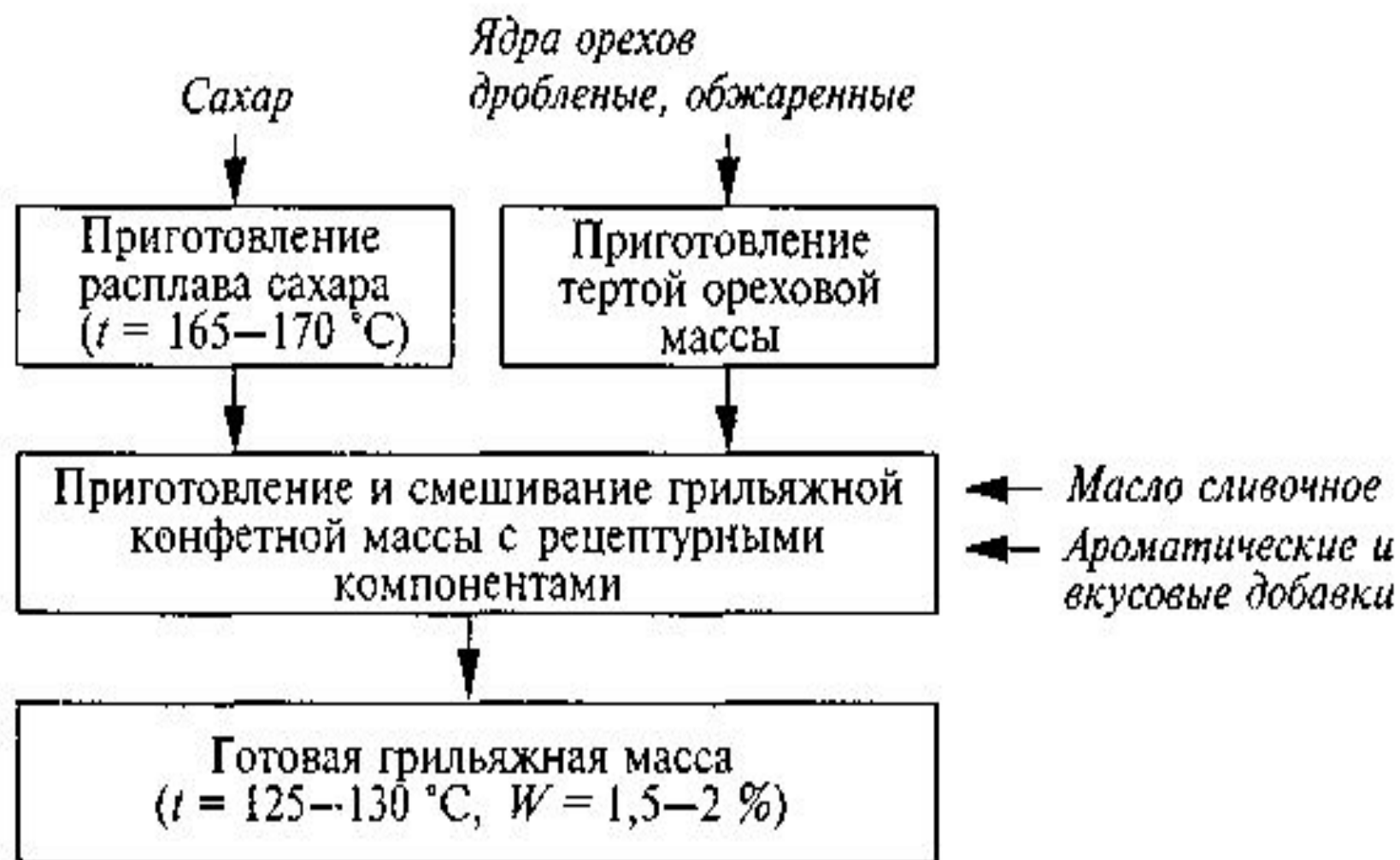
Рис. 27. Технологическая схема приготовления грильяжных конфетных масс
