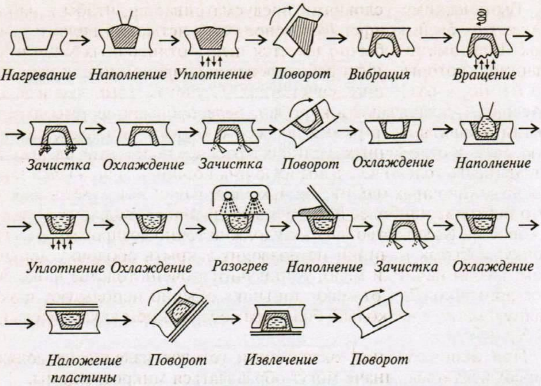
Рис 8 Технологическая схема формования конфет типа «Ассорти»
