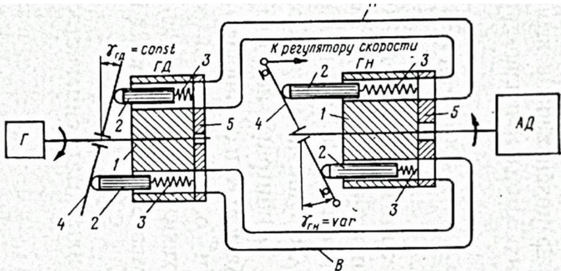
Рис. 4.12. Принципиальная схема прямой гидравлической передачи с плунжерным насосом и двигателем
