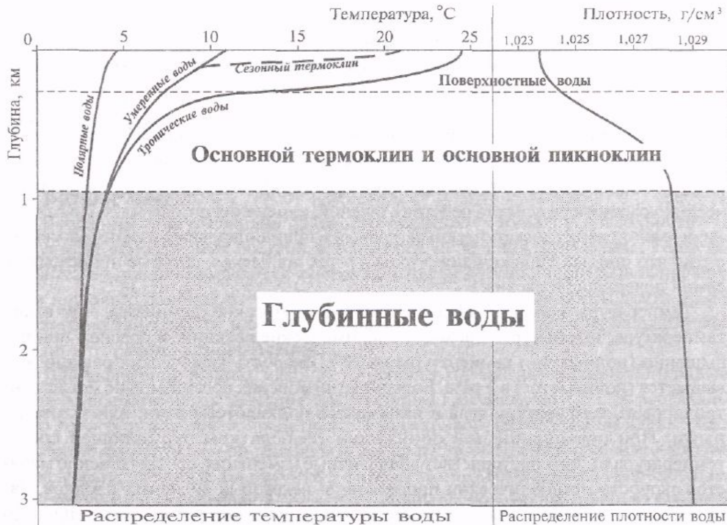
Рис. 3. Характерное распределение температуры и плотности воды в разных широтах Мирового океана
