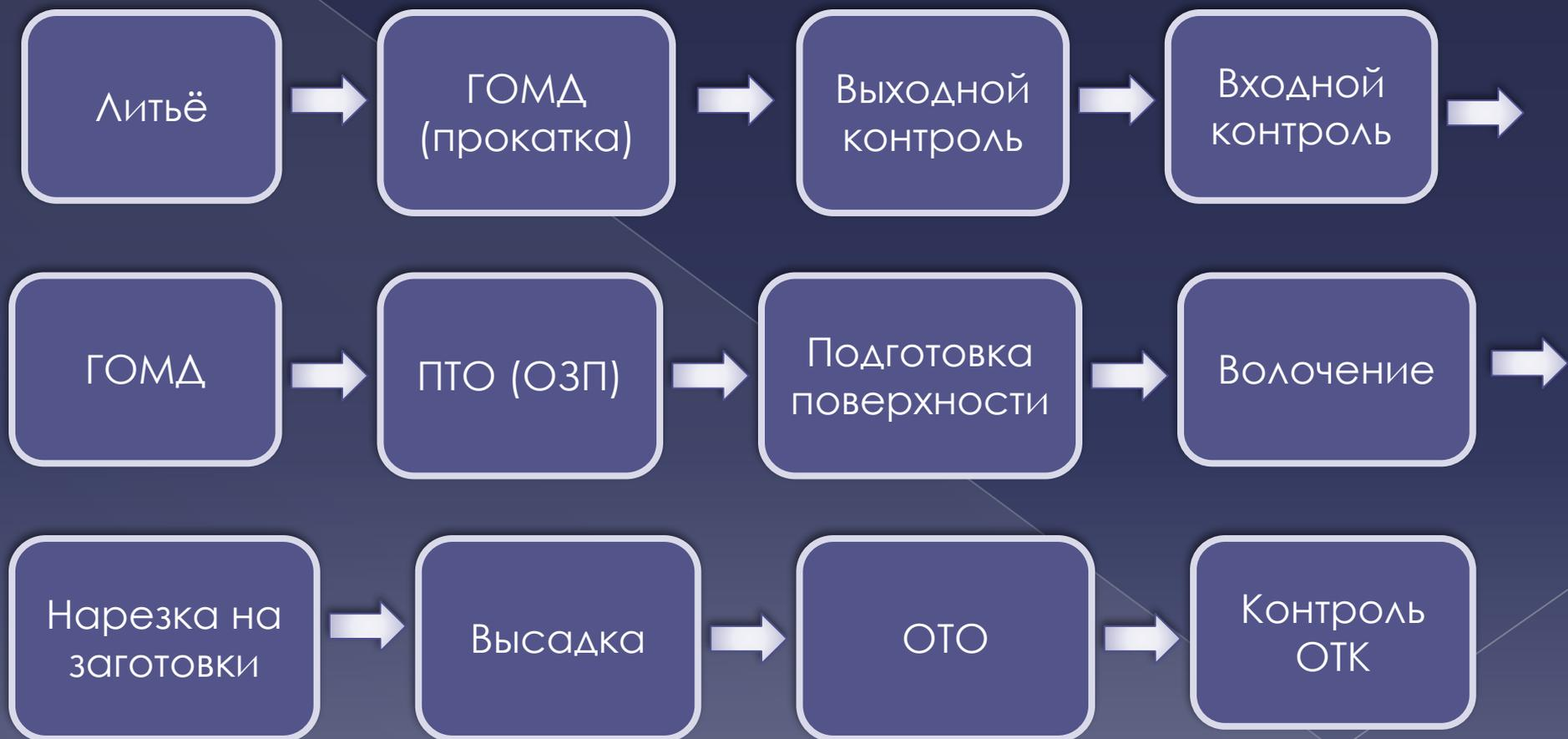
Рисунок 3 – Схема технологического процесса
