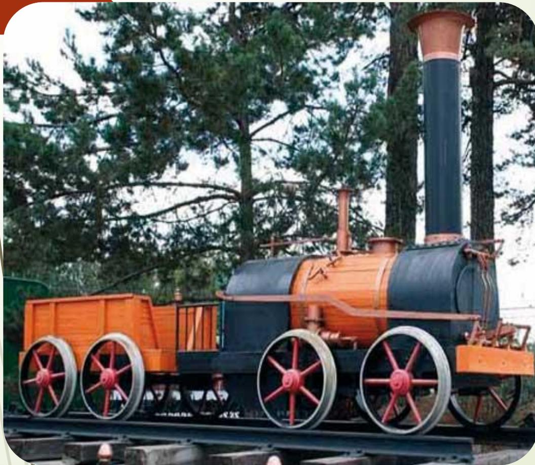
□ Вес паровоза Черепановых составлял 2,4 тонны. С грузом в 3,5 тонны, паровоз развивал скорость в 15 км/ч. Для перевозки запасов угля и воды, применялась специальная тележка - тендер.
