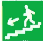
E 14 Направление к эвакуационному выходу по лестнице вверх
