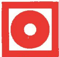
F 10 Кнопка включения установок (систем) пожарной автоматики
