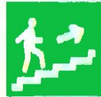
E 15 Направление к эвакуационному выходу по лестнице вперед
