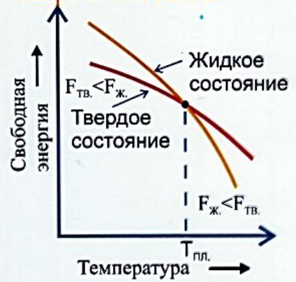
Схема процесса кристаллизации
