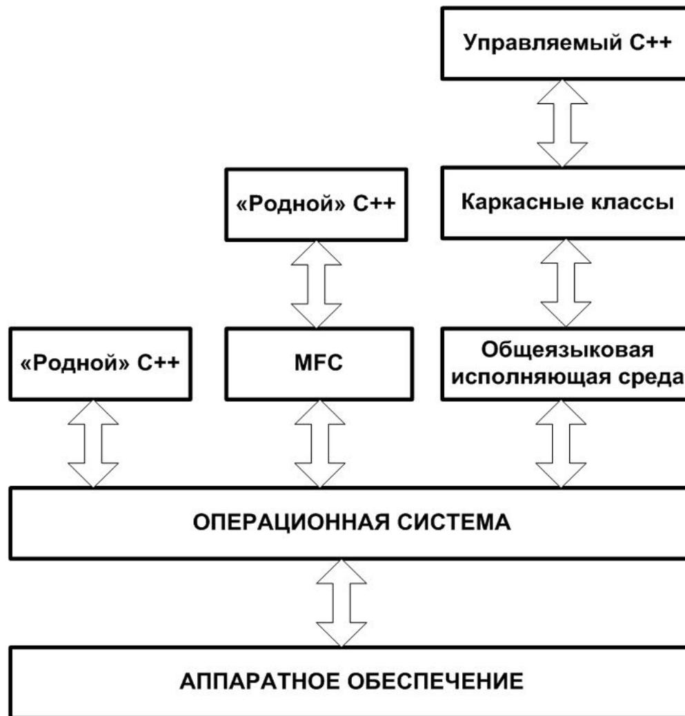
Рисунок 1.1 – Способы разработки приложений в среде Visual C++ 2010
