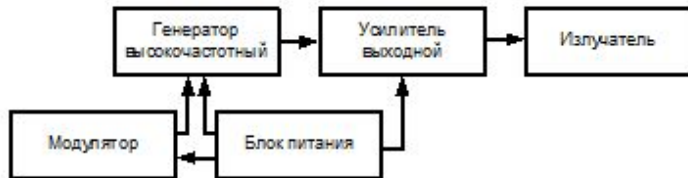
Рисунок 1 – Структурная схема аппарата УЗТ
