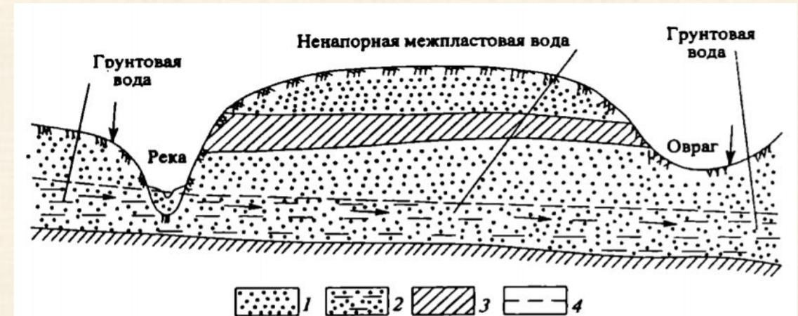
Рис. 3.9. Схема залегания потока межпластовых ненапорных вод:
