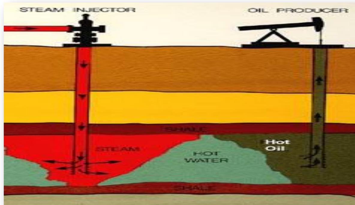
При сжигании 1 т нефти в парогенераторах можно получить 13-15 т пара, поэтому при рентабельной технологии удельный расход пара на дополнительную добычу нефти не может быть больше 13-15 т.
