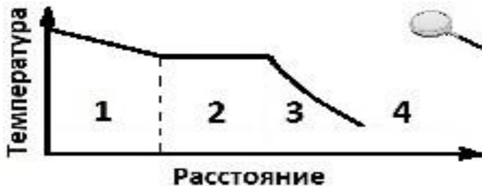
Схема распределения температуры в пласте при нагнетании в него водяного пара
