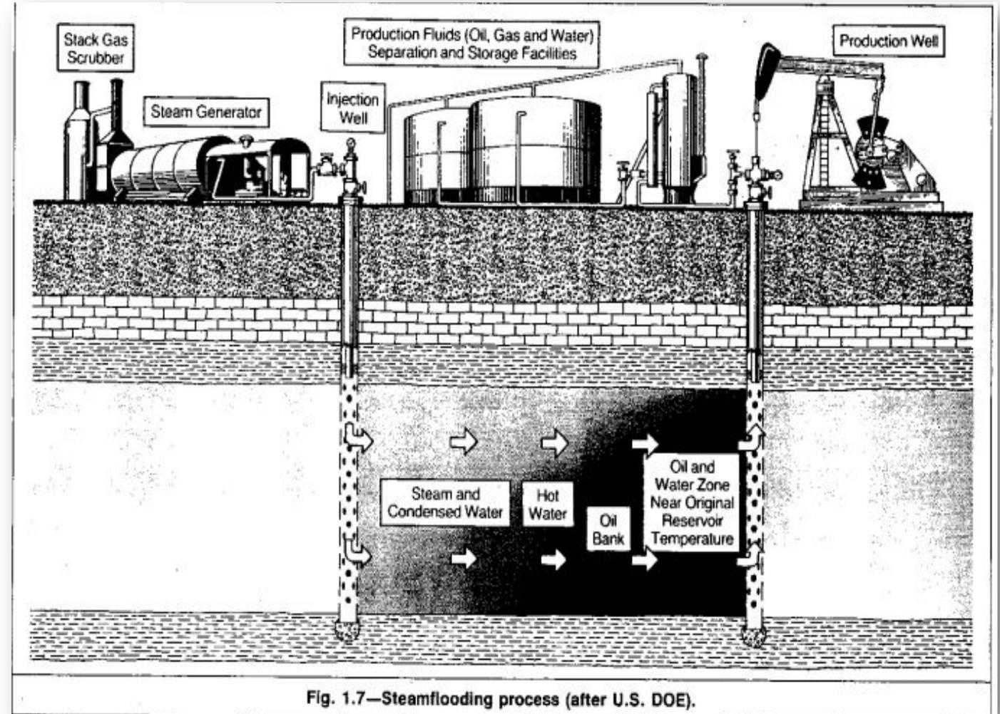
С целью повышения эффективности процесса и рационального использования внесенного в пласт тепла, после создания тепловой оторочки, составляющей 0,6-0,8 порового объема пласта, эту оторочку продвигают к забоям добывающих скважин ненагретой водой путем закачки ее в те же нагнетательные скважины.
