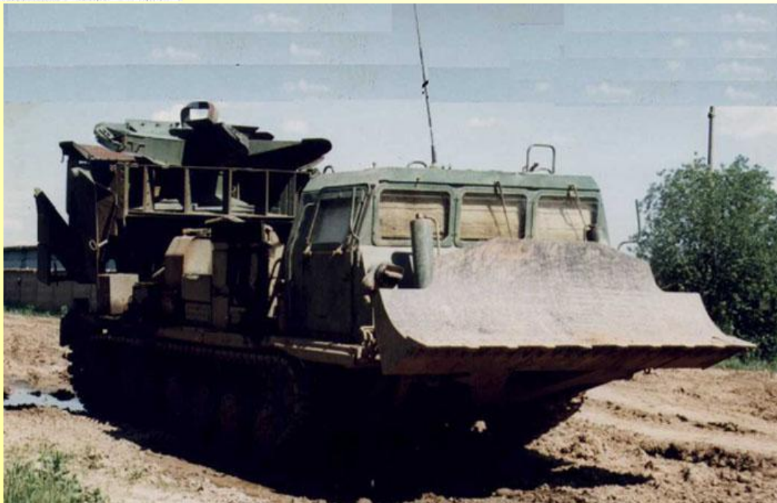
Котлованная машина МДК-3
