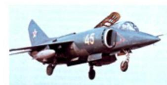
Самолет Як-38М, оснащенный 23-мм двустольной пушкой ГШ-23
