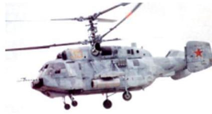
Вертолет Ка-29, оснащенный 7,62-мм четырехствольным пулеметом ГШГ-7,62 и пушкой ГШ-30
