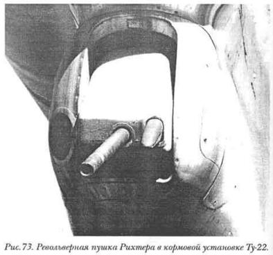
Рис. 73. Революционная пушка Гихтера в кормовой установке Ту-22.
