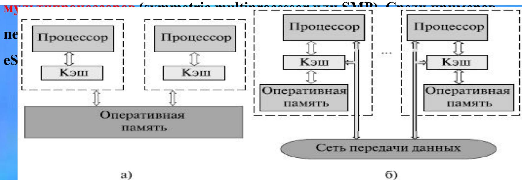
Рис. 1. Архитектура многопроцессорных систем с общей (разделяемой)
