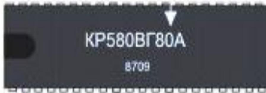
Последний символ в маркировке микросхем указывает на какие-либо особенности в её электрических характеристиках.
