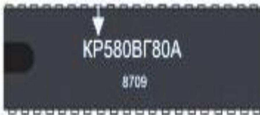
Следующая за типом корпуса цифра характеризует принадлежность ИМС к той или иной конструктивно-технической группе.
