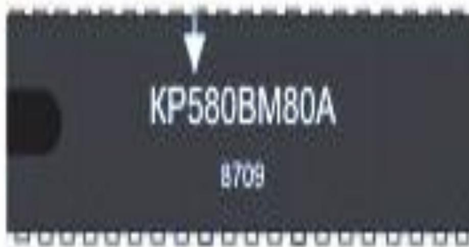
Следующие две цифры обозначают номер серии.
