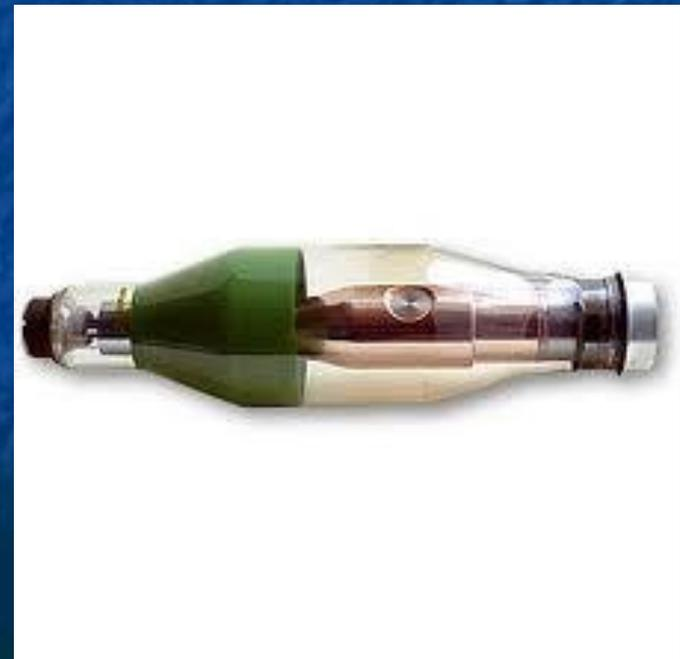
Сплошной (тормозной) рентгеновский спектр возникает при *торможении* бомбардирующих анод рентгеновской трубки быстрых электронов. Определяется только энергией бомбардирующих анод электронов и не зависит от материала анода.
