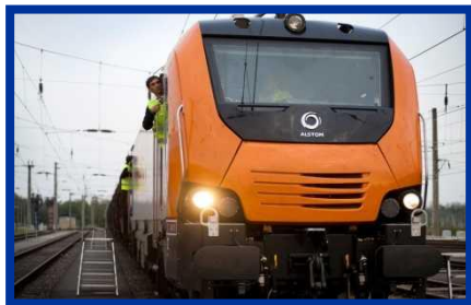
Prima II –4 системный – 6 400 кВт
