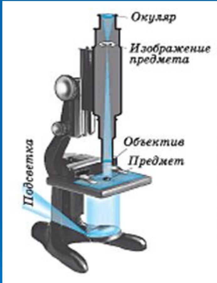
Простейшая модель микроскопа состоит из двух короткофокусных собирающих линз.
