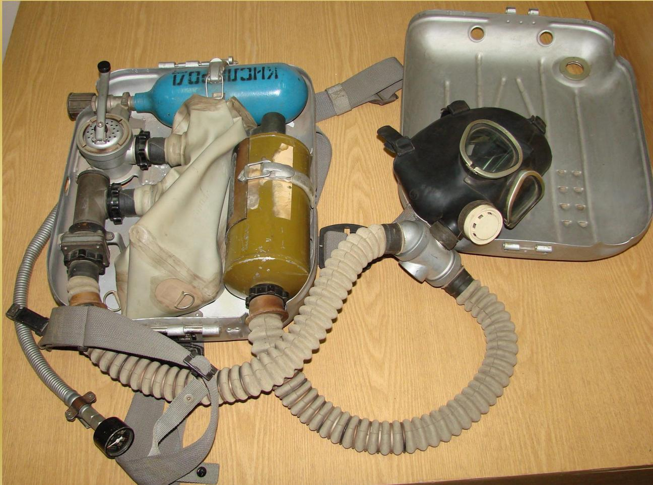
**Ребризер** (от англ. **re** - приставка, обозначающая повторение к.л. действия, и англ. **breath** - дыхание, вдох) **дыхательный аппарат**, в котором углекислый газ, выделяющийся в процессе дыхания, поглощается химическим составом (химпоглотителем), затем смесь обогащается кислородом и подаётся на вдох.
