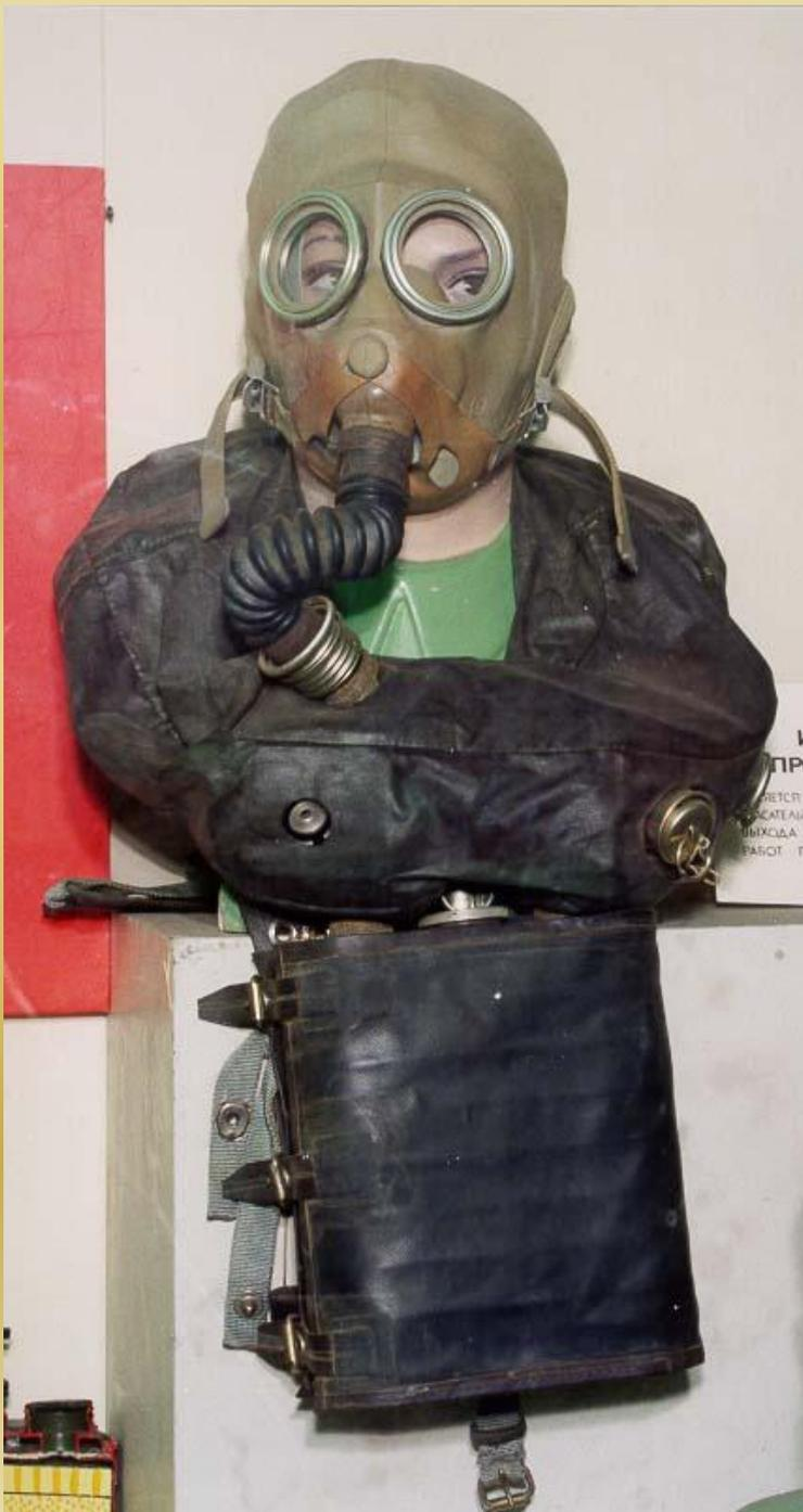
**Изолирующий противогаз ИП-5** предназначен для выхода из затепленных (затонувших) объектов бронетанкового вооружения методом свободного всплытия со скоростью 1 м/сек или методом постепенного подъёма на поверхность воды, а также позволяет выполнять под водой лёгкие работы и может использоваться на суше.
