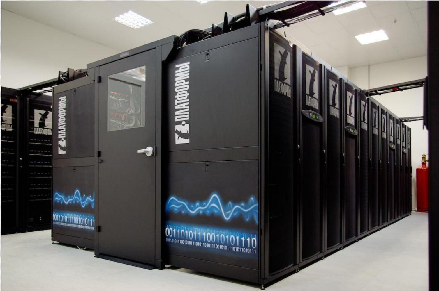
*60 Tflop/s, 1250 процессоров Intel Xeon (\*4 ядра)*
