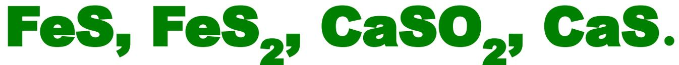
**Значительная часть серы удаляется в виде летучих соединений ( $SO_2$ ,  $H_2S$  и др.), другая часть переходит в сплав ( $FeS$ ) или в шлак ( $CaS$ ).**
