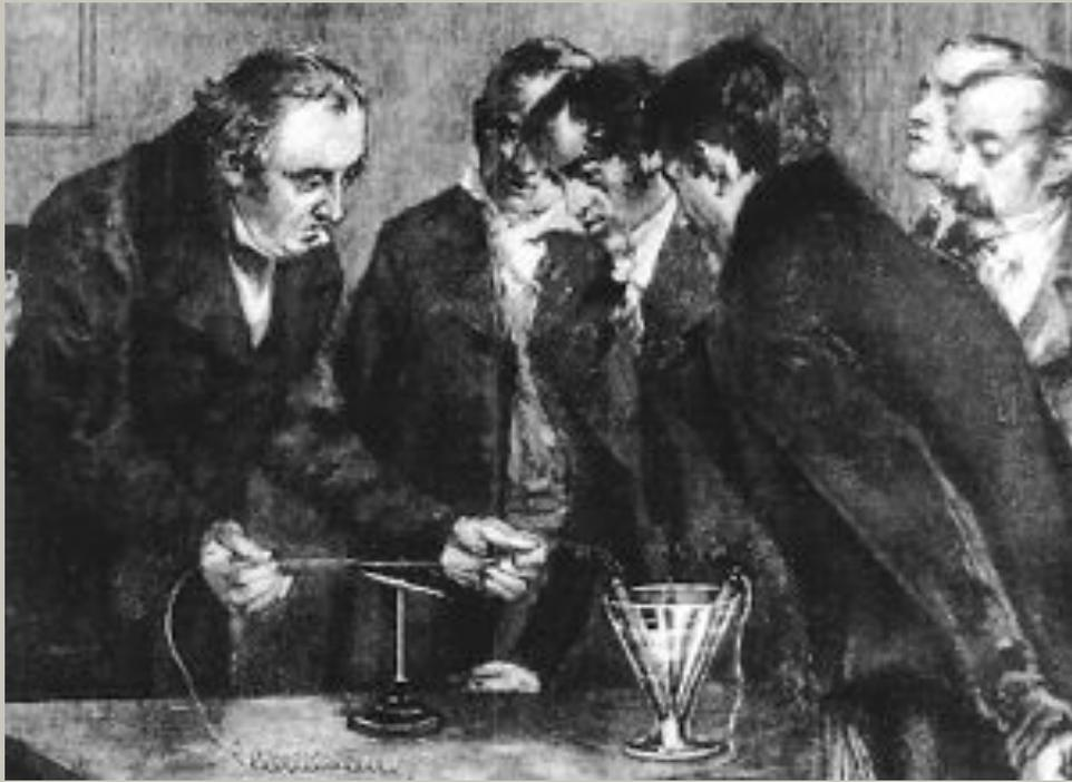
Важнейшая научная заслуга Эрстеда - установление связи между магнитными и электрическими явлениями в опытах по отклонению магнитной стрелки под действием проводника с током.
