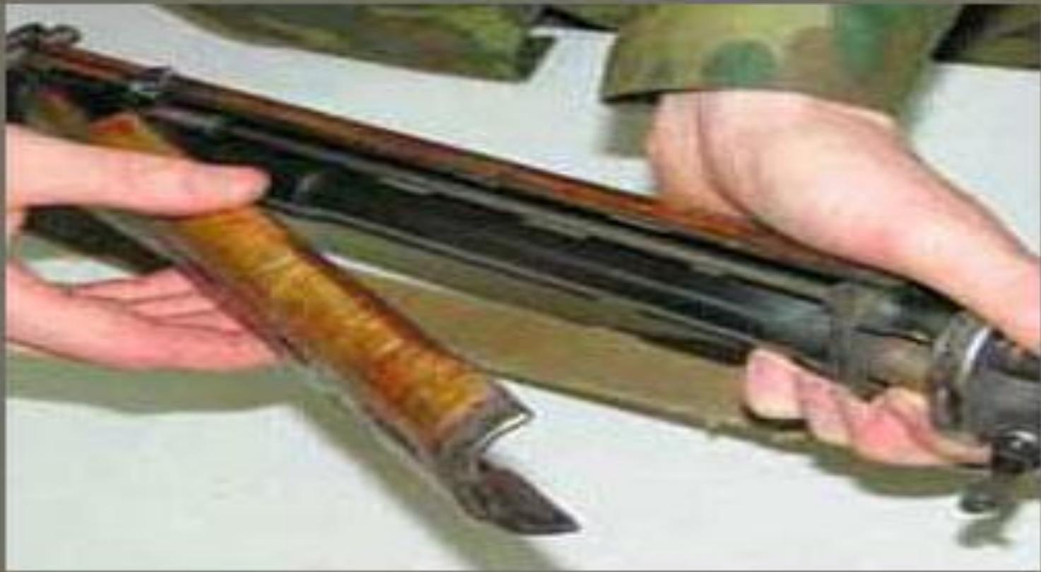
9) Отделить газовый поршень и толкатель с пружиной. Отвести толкатель назад, вывести его передний конец из гнезда поршня и отделить от газовой трубки поршень, ввести передний конец толкателя в газовую трубку, поджать пружину толкателя до выхода ее из канала прицельной колодки и отделить толкатель с пружиной, а затем отделить пружину от толкателя.
