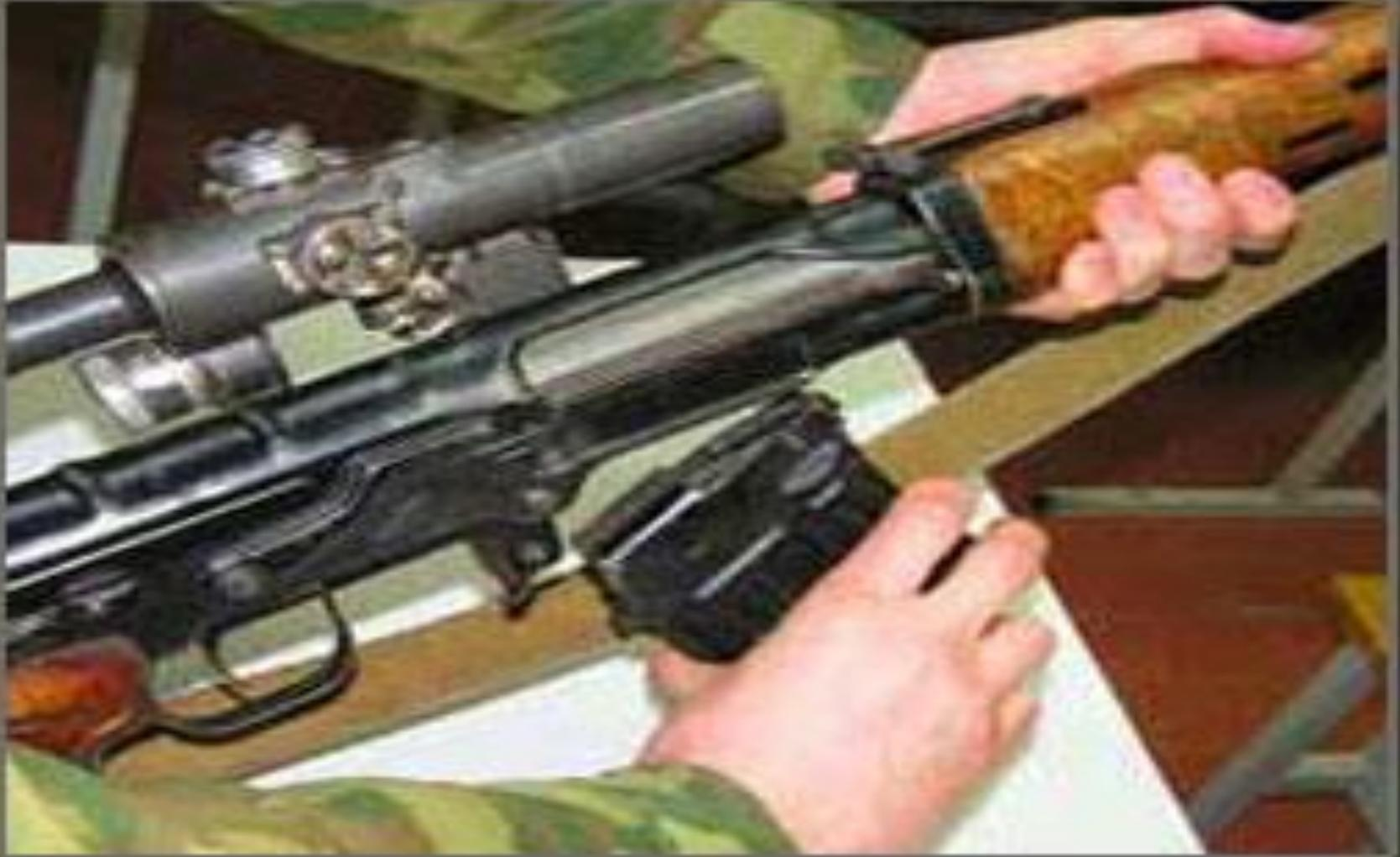
2) Отделить оптический прицел. Приподнять ручку зажимного винта и повернуть ее в сторону наглазника до отказа, двинуть прицел назад и отделить его от ствольной коробки.
