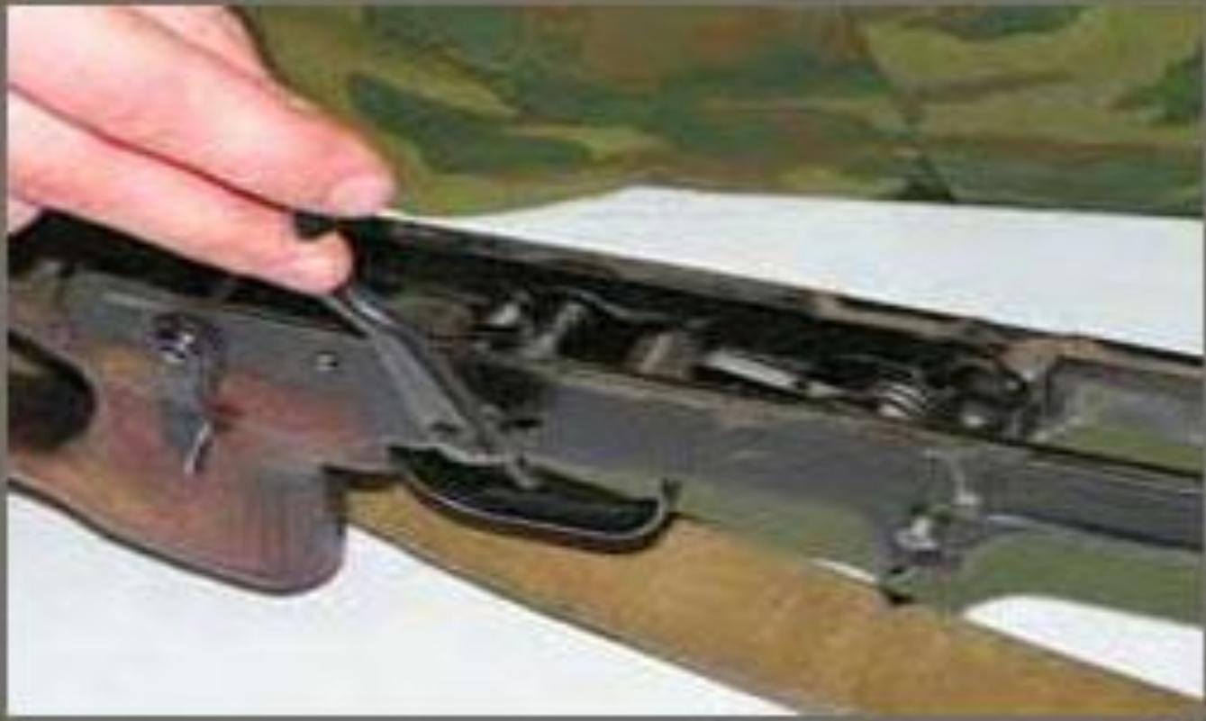
8) **Отделить ствольные накладки.** Прижать замыкатель верхнего упорного кольца к газовой трубке до выхода отгиба замыкателя из выреза кольца и повернуть замыкатель вправо до отказа; сдвинуть перемещающуюся часть верхнего упорного кольца вперед, нажимая ствольную накладку вниз и отводя в сторону, отделить ее от ствола. В случае затруднительного отделения ствольных накладок вставить вырез ключа пенала в окно накладки и движением вниз и в сторону отделить ствольную накладку
