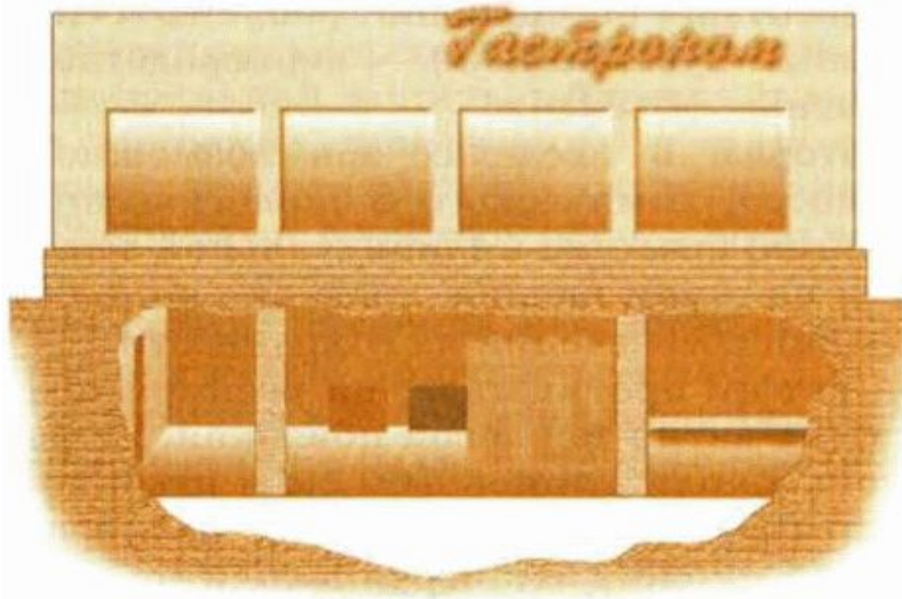
Встроенное защитное сооружение (убежище)
