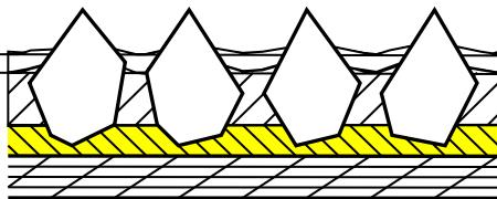
Основной связующий слой предварительно прикрепляет зерна к основе.
