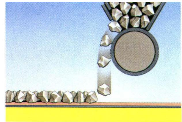
Абразивные материалы, при производстве которых используется механический способ нанесения зерна, менее агрессивны.
