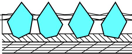
Номер абразива (P16) соответствует размеру зерна, которое должно проходить в ячейку сетки, получаемую при делении одного квадратного дюйма на равное количество частей (16 по вертикали и 16 по горизонтали).
