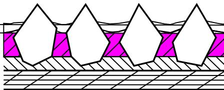
Связующий слой прочно скрепляет зерна с основой и между собой, предотвращая выкрашивание зерна при работе. При производстве абразивов, в основном, в связующем слое используются синтетические смолы, с каждым годом сокращается использование мездровых клеев.
