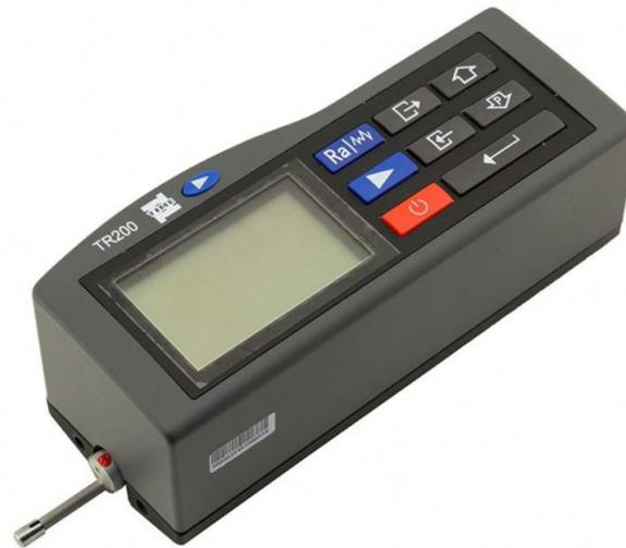
Щуп профилометра с алмазным наконечником
