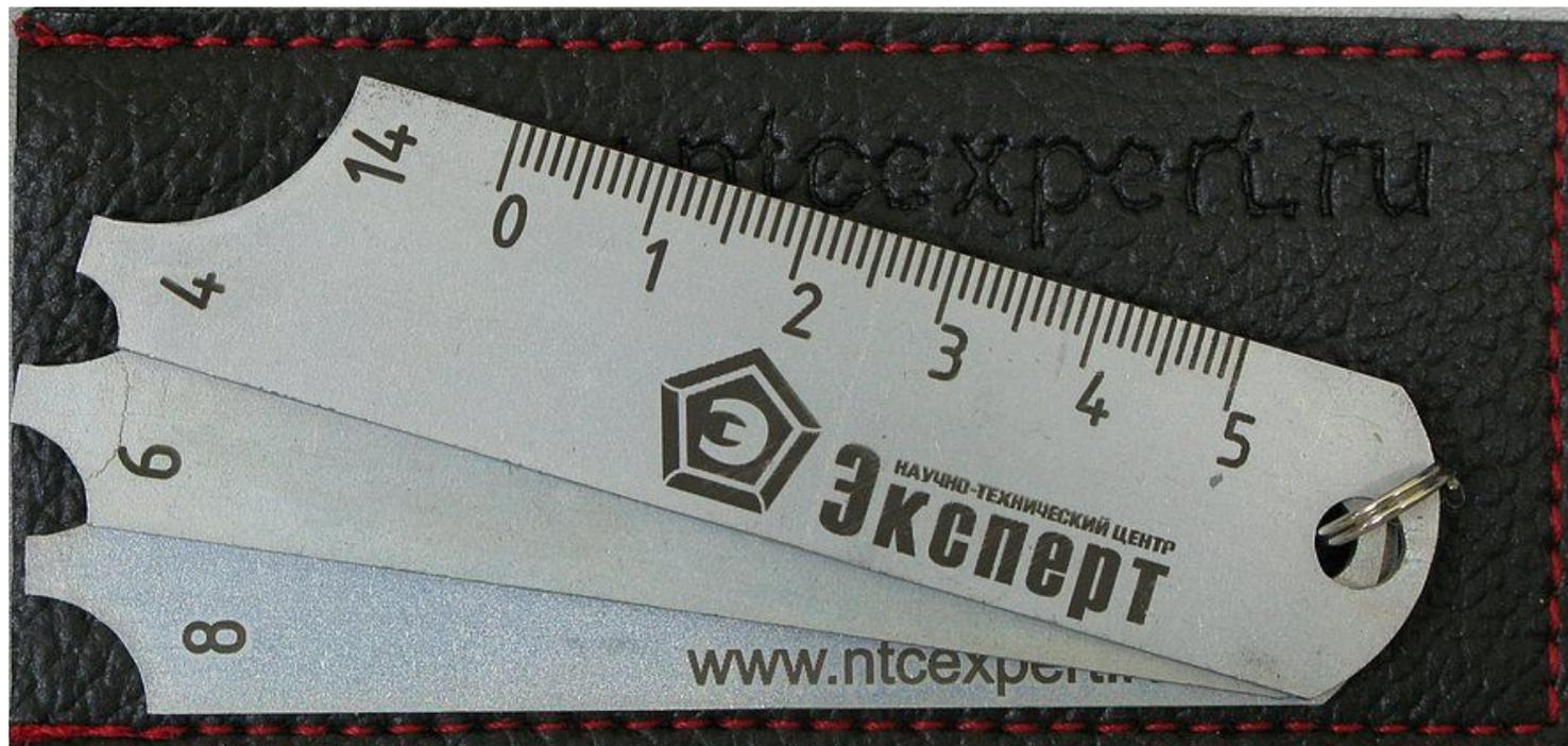
**Шаблон сварщика УШС-2** предназначен для контроля катетов угловых швов в диапазоне 4-14 мм в соответствии с требованиями СТБ 1133-98.
