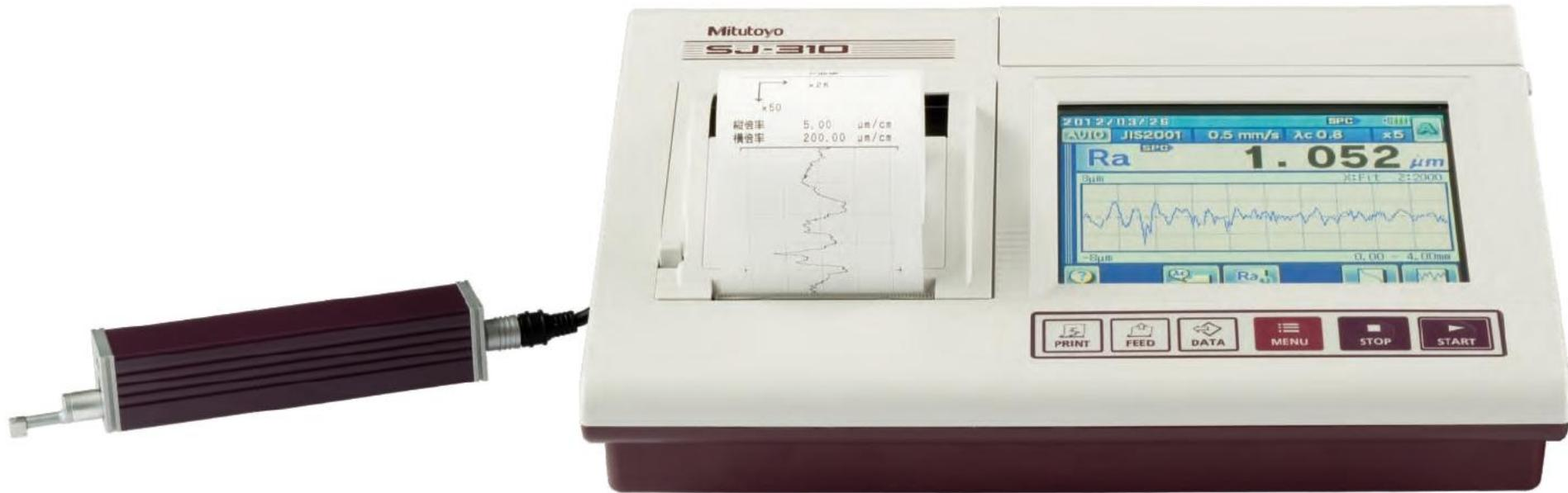
**Профилограф** выдает результаты измерений после полного исследования в виде графика **-профилограмма**, представляющего собой кривую линию. Он нуждается в техническом анализе и расшифровке. Погрешность прибора не выходит за границы  $\pm 5...10\%$ .
