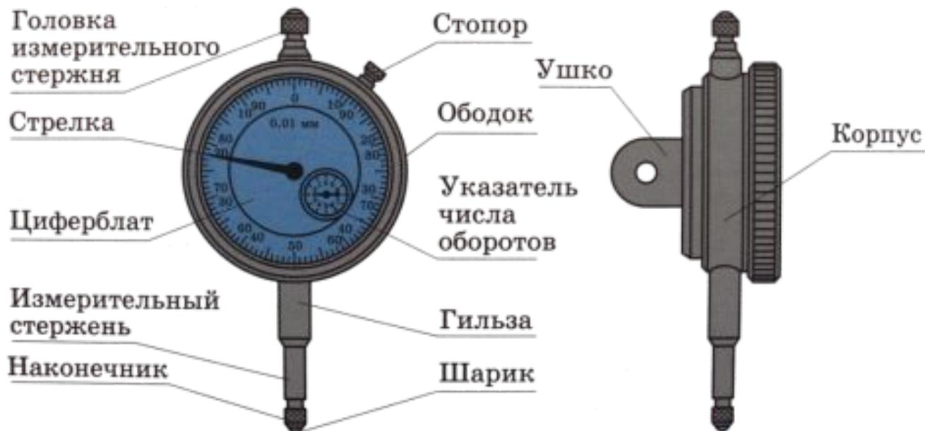
Индикатор часового типа 0-1 мм 0.001 мм класс 1
