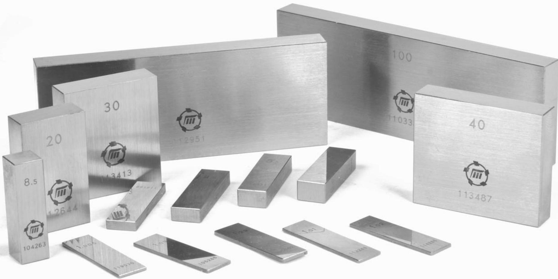
**Плоско параллельные концевые меры длины** (ГОСТ 9038—73) или плитки представляют собой стальные закаленные параллелепипеды, у которых две противоположные измерительные грани расположены на исключительно точном расстоянии  $L$  и обработаны с наименьшими возможными шероховатостью, погрешностью формы и отклонением от параллельности.
