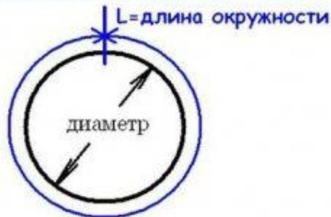
$$\text{Диаметр} = \frac{\text{Длина окружности}}{\text{число } \Pi \text{ } 3,1416}$$
