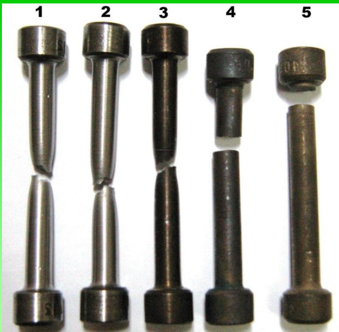
Внешний вид образцов после испытаний на разрыв: 1 – исходный; 2 – снятый слой; 3 – слой 0,08мм; 4 – 0,25мм, 5 – 0,35мм
