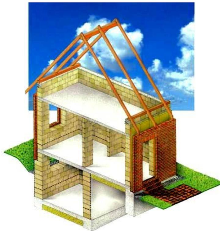
**Рис. 1. Бескаркасное здание**
