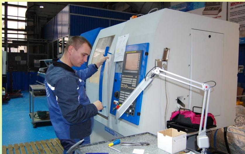
*Оператор станков с программным управлением* – это важнейшее звено в производственном процессе. Его работа заключается в программировании и наладки станков с числовым программным управлением, а также в контроле и регулировки процесса по обработке деталей
