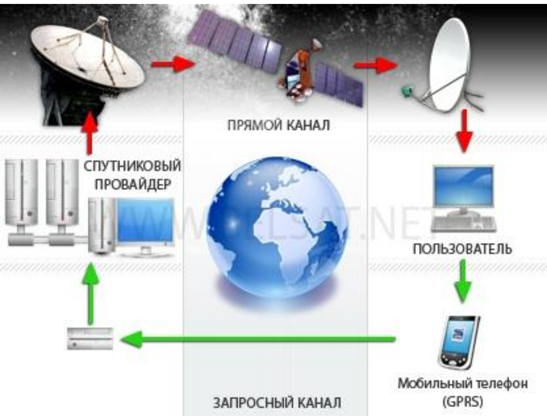
Схема организации асимметричного спутникового канала связи
