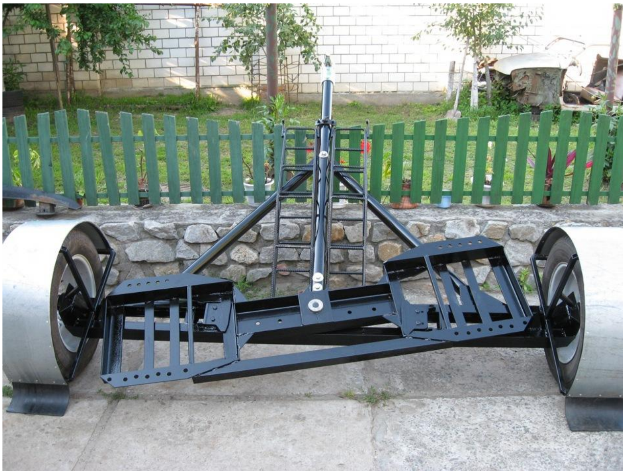
Рисунок 2 – прицеп с поворотной платформой
