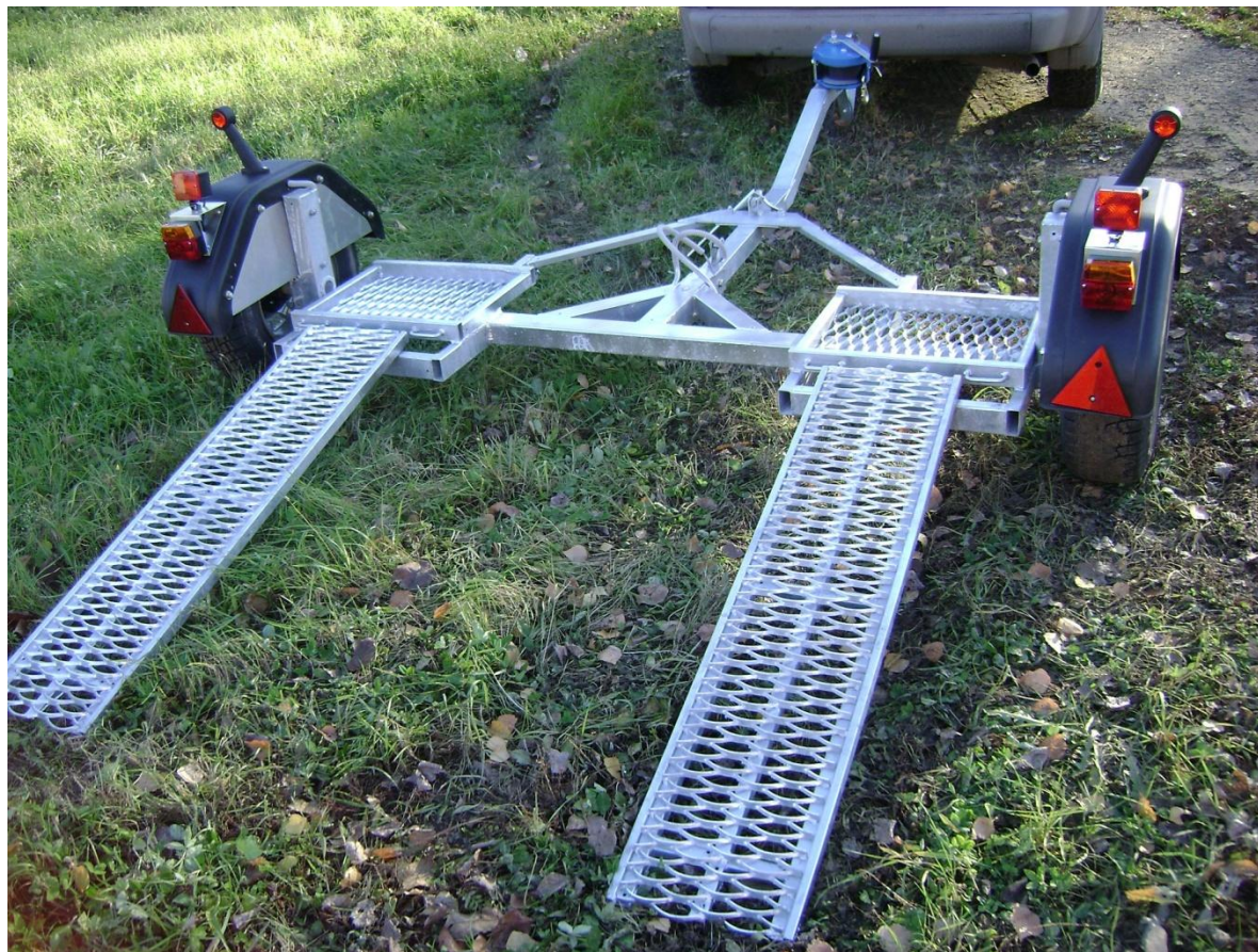
Рисунок 1 – прицеп с монолитной несущей частью
