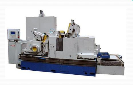
предназначен для шлифования цилиндрических гладких и прерывистых поверхностей многоступенчатых валов в условиях мелкосерийного и серийного производства.
