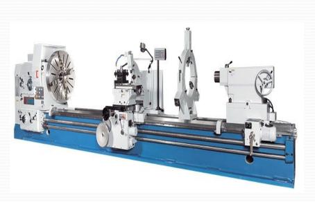
Универсальный тяжёлый токарный станок – предназначен для выполнения самых разнообразных операций: обработки наружных и внутренних цилиндрических, конических, фасонных и торцовых поверхностей; нарезания наружных и внутренних резьб; отрезки, сверления, зенкерования и развертывания отверстий.
