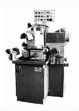
Универсально заточной станок – предназначен для заточки свёрл, фрез, метчиков.
