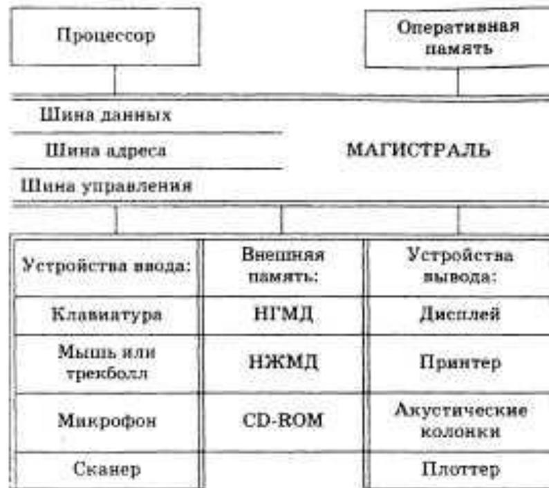
Схема магистрально-модульного принципа построения ПК
