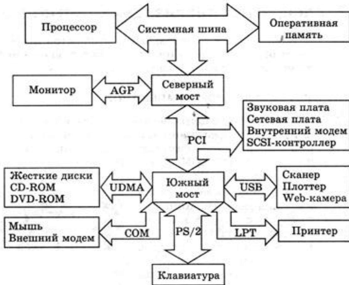
Схема магистрально-модульного принципа построения ПК
