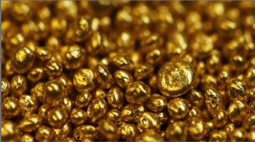
Золото — желтый металл . Температура плавления  $1064,4\text{ }^{\circ}\text{C}$ , температура кипения  $2880\text{ }^{\circ}\text{C}$ , плотность  $19,32\text{ кг/дм}^3$ . Обладает исключительной пластичностью, теплопроводностью и электропроводимостью. Шарик золота диаметром в 1 мм можно расплющить в тончайший лист, просвечивающий голубовато-зеленым цветом, площадью  $50\text{ м}^2$ . Толщина самых тонких листочков золота  $0,1\text{ мкм}$ . Из золота можно вытянуть тончайшие нити.
