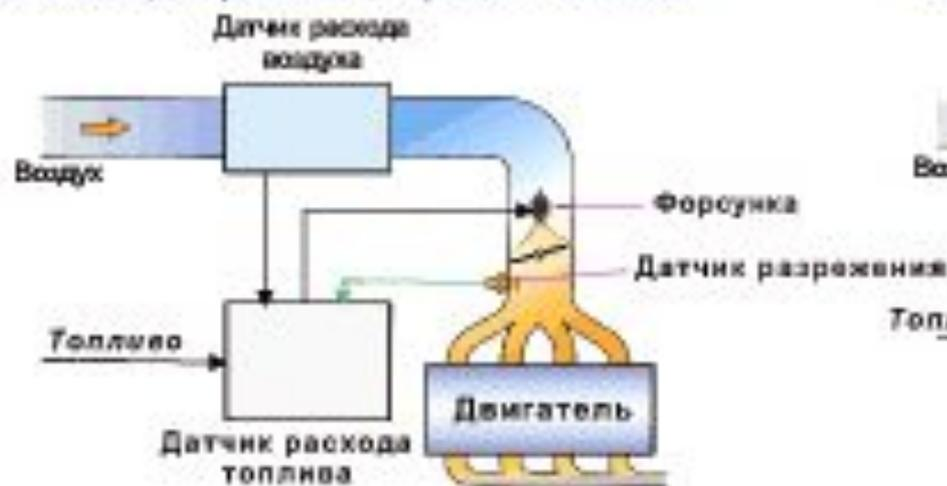
Система распределенного впрыска топлива
