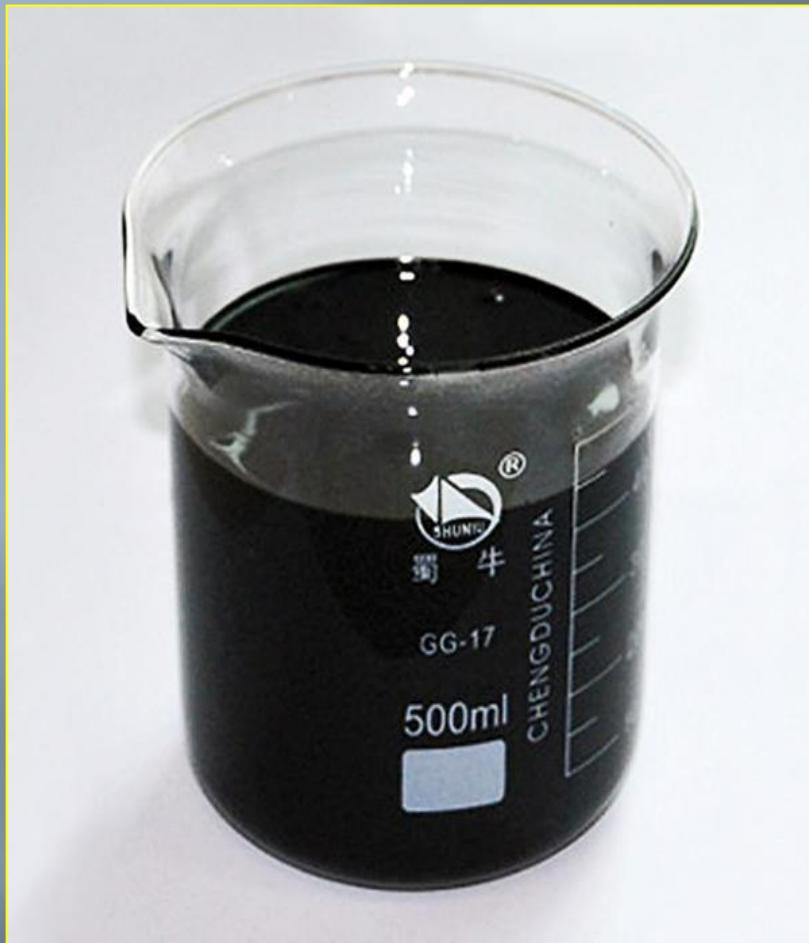
В составе нефти выделяют углеводородную, асфальтосмолистую и зольную составные части. Также в составе нефти выделяют порфирины и серу.
