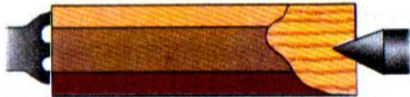
трезубцем с поджатием центром пиноли задней бабки
