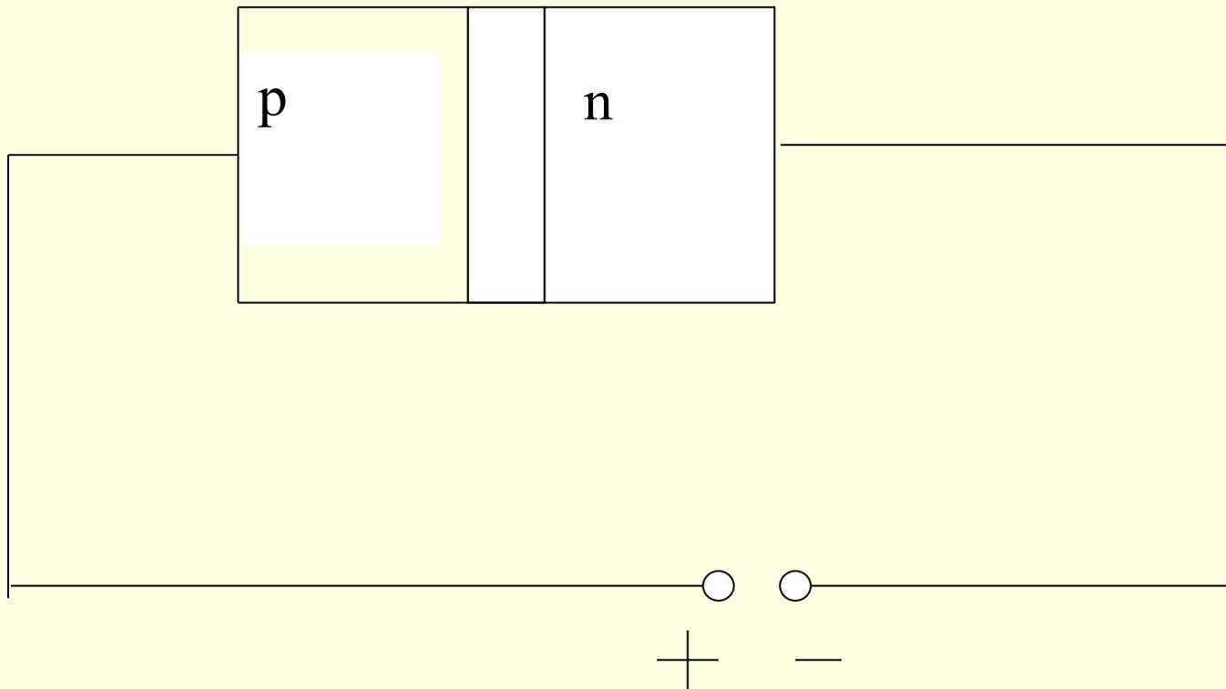
При обратном подключении полюса источника напряжения «тянут» электроны и дырки в разные стороны, барьер становится непреодолимым.
