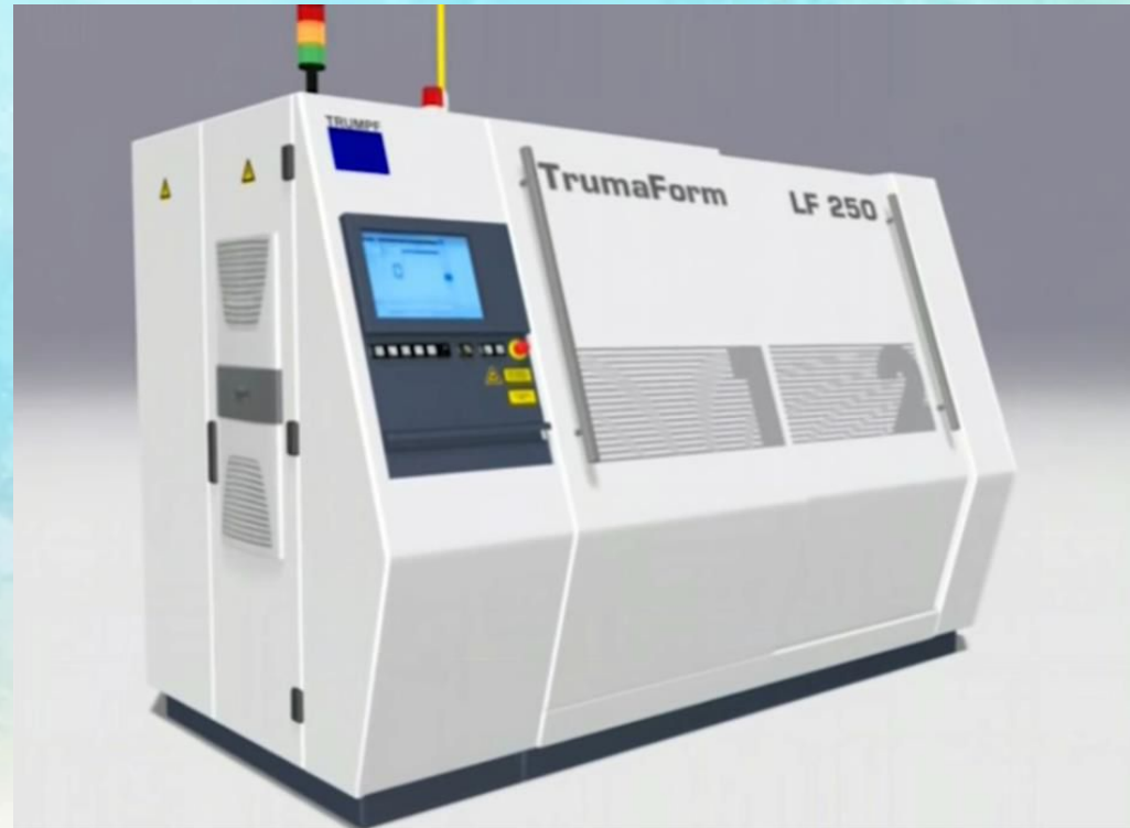
Рис. 7 - Прямая лазерная формование: машина TrumaForm LF 250.
