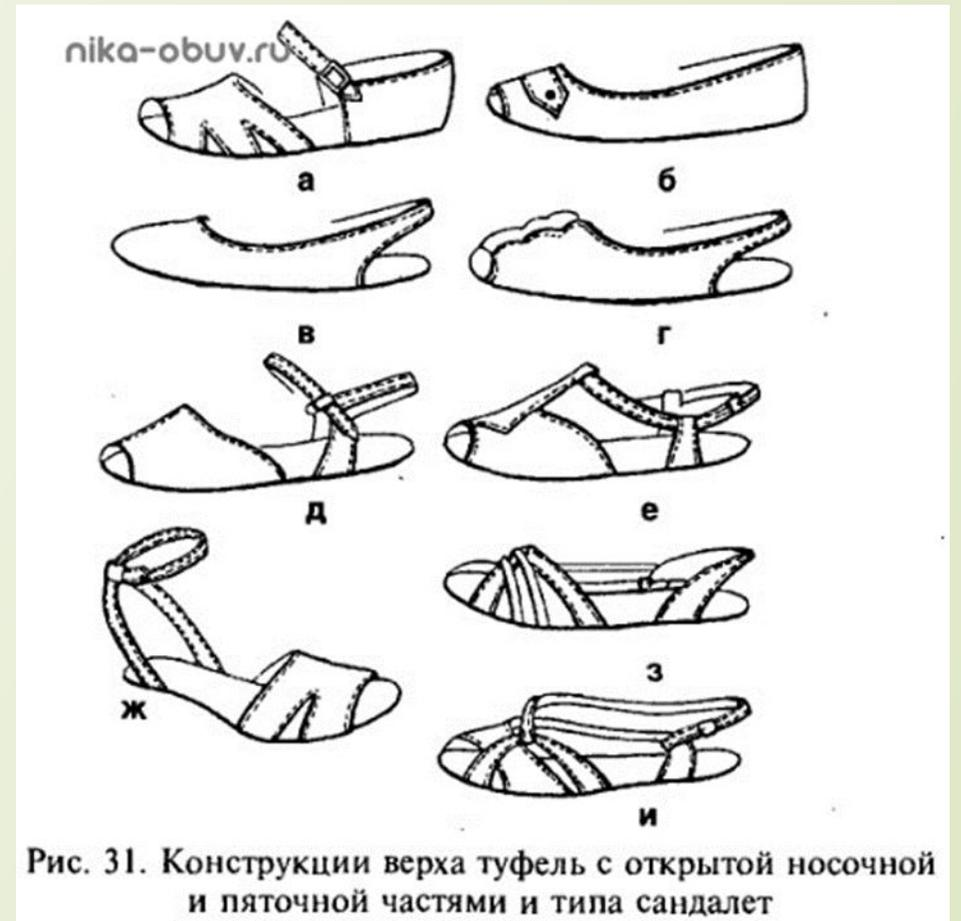
Рис. 31. Конструкции верха туфель с открытой носочной и пяточной частями и типа сандалет
