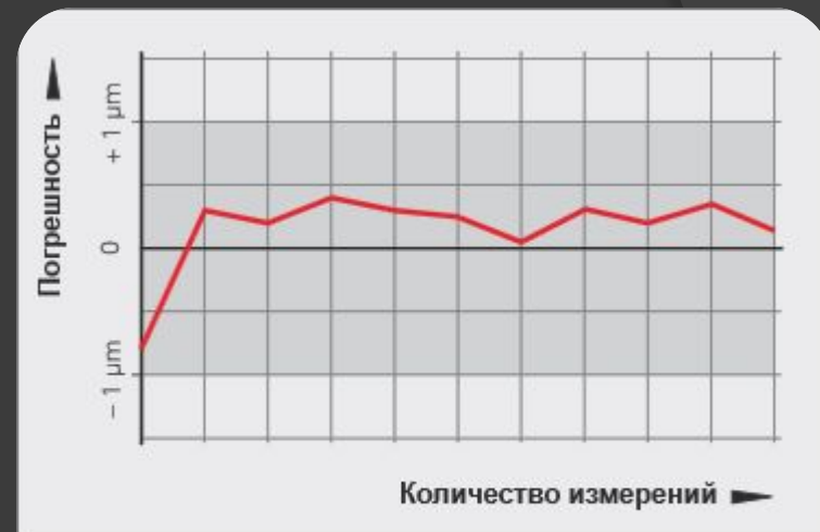
Типичная диаграмма повторяемости результатов измерений 3D-щупа TS 2xx/4xx/6xx: многократные измерения в одном направлении и определенной ориентации шпинделя
