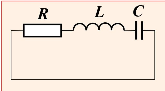
Состав: последовательно включенные резистор сопротивлением  $R$ , катушка индуктивностью  $L$ , и с конденсатор емкостью  $C$ .
