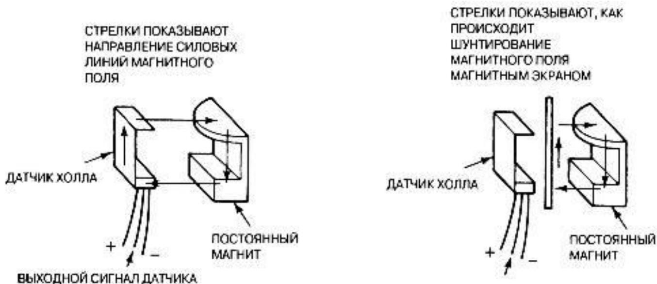
**Рис.** В интегральном датчике Холла используются металлические дисковые обтюраторы, шунтирующие силовые линии магнитного поля, экранируя от него датчик Холла, изготовленный по микроэлектронной технологии вместе со схемой усиления. Все интегральные датчики Холла формируют прямоугольные импульсы, обеспечивающие очень точную синхронизацию работы модуля управления зажиганием
