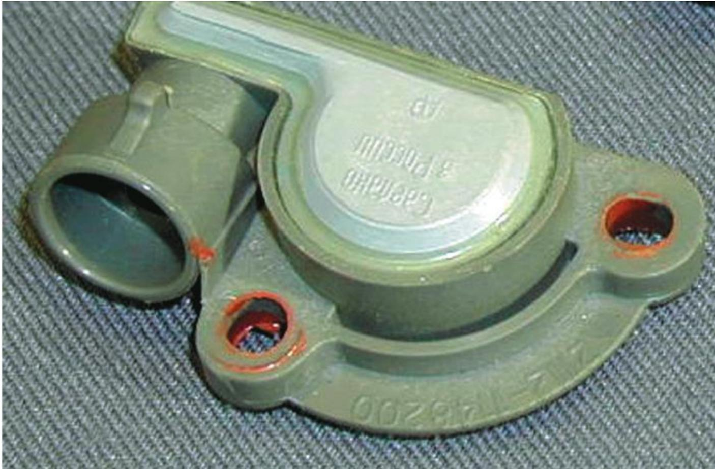
Рис. Датчик положения дроссельной заслонки
