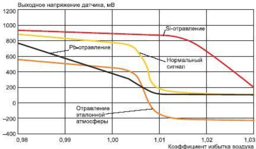
Рис. 10. Влияние различных факторов на характеристики датчика кислорода
