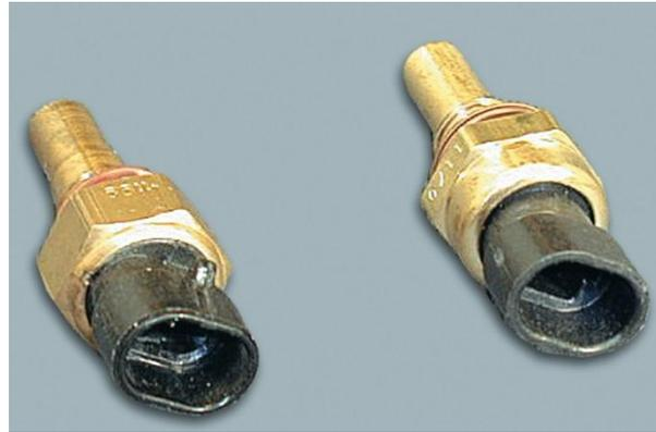
Датчик температуры охлаждающей жидкости
