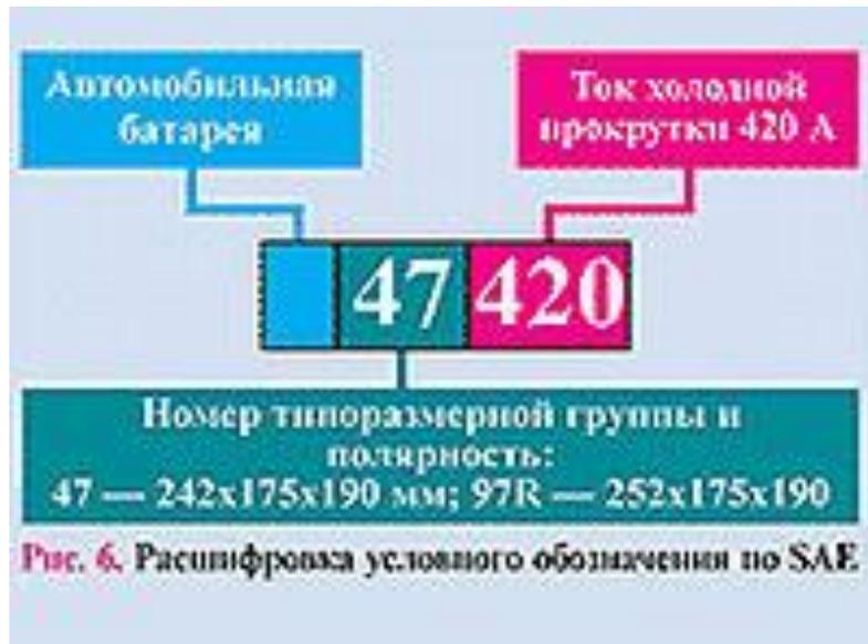
Согласно стандарту SAE J537 (Society of Automotive Engineers) на батареях американского производства наносится:
