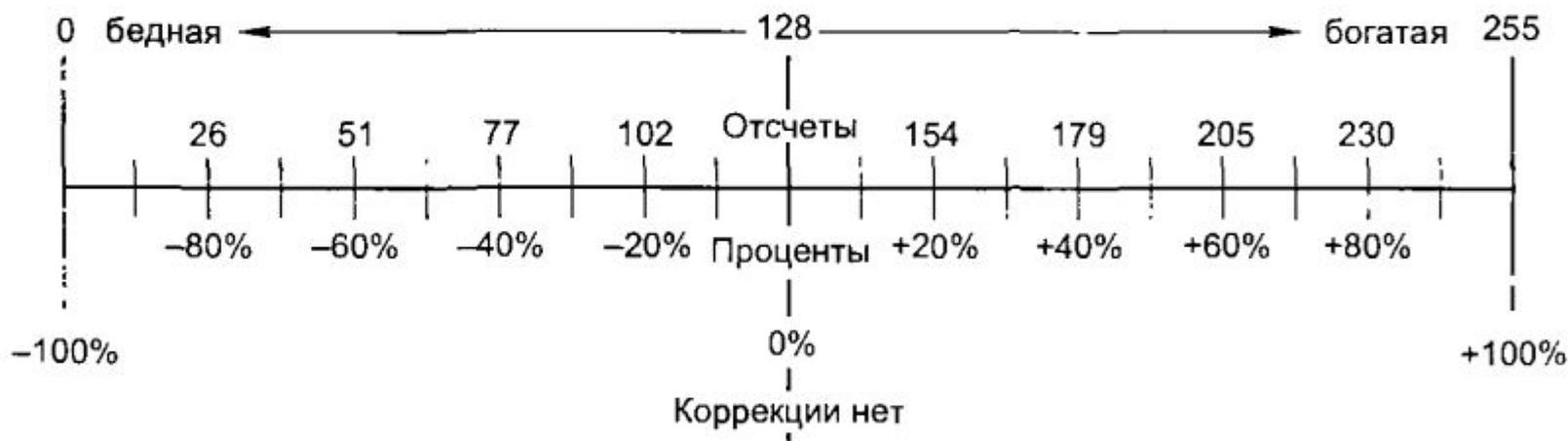
Рисунок 12.7- Шкала коэффициентов топливокоррекции [26]
