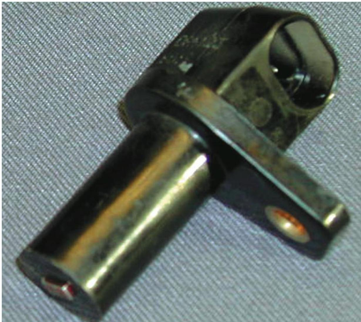
Датчик положения коленчатого
