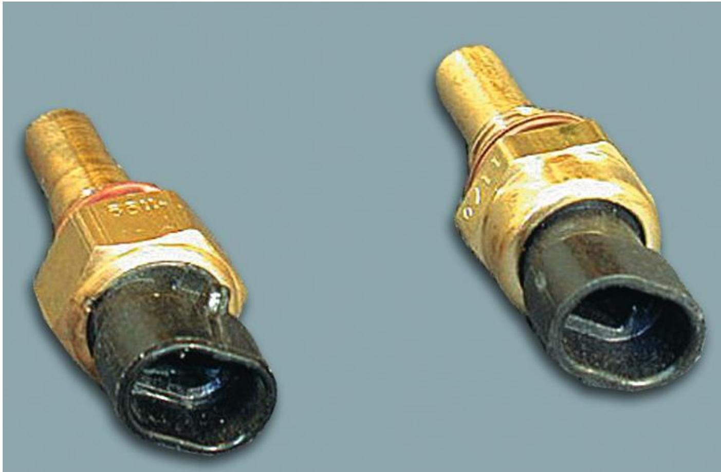
**Датчик температуры охлаждающей жидкости**
