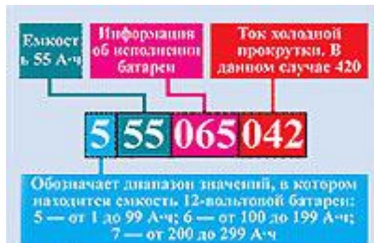
Рис. 5. Расшифровка условного обозначения по EN
